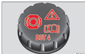
Fig. 52 Vano motor: tapón del depósito del líquido de frenos.
