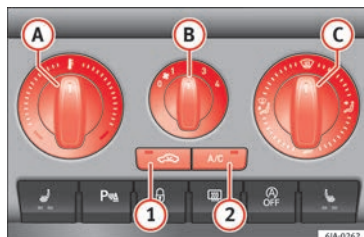
Fig. 46 En la consola central: mandos del aire acondicionado manual.
