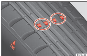
Fig. 213 Perfil de los neumáticos con indicadores de desgaste.
