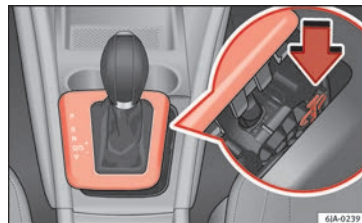
Fig. 44 Desbloqueo de emergencia de la palanca selectora.
