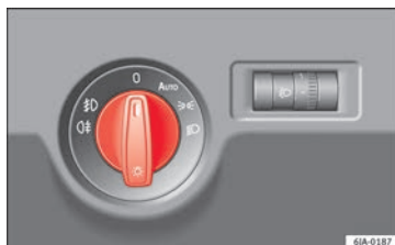
Fig. 129 Cuadro de instrumentos: mando de las luces.
