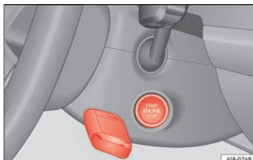
Fig. 174 Arranque de emergencia en vehículos con Keyless Access.
