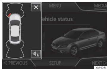
Fig. 183 Indicación en miniatura de la activación automática
