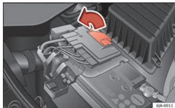
Fig. 211 Batería: abertura de la cubierta.
