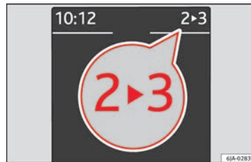
Fig. 37 Cuadro de instrumentos: indicación de las marchas (cambio manual).
