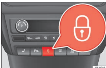
Fig. 2 Consola central: conmutador del cierre centralizado.
