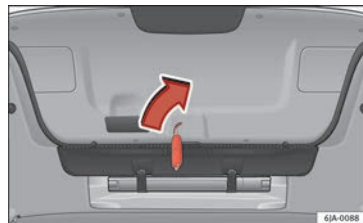
Fig. 6 Detalle del maletero: acceso al desbloqueo de emergencia.
