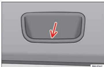
Fig. 127 Detalle del guarnecido interior del portón trasero: cavidad para tirar.
