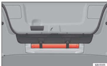
Fig. 82 Emplazamiento del triángulo de preseñalización.
