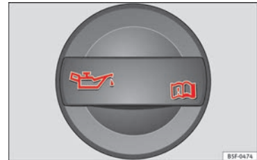
Fig. 50 Tapón de la boca de llenado de aceite del motor en el vano motor.
