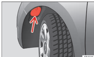
Fig. 91 Cambio de lámpara de la luz de cruce: pasarruedas.
