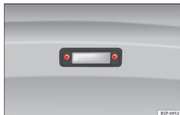
Fig. 107 Desmontaje de la iluminación placa matrícula.
