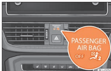
Fig. 19 Tablero de instrumentos: testigo de control de la desactivación del airbag del acompañante.
