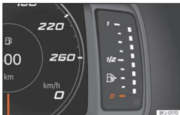
Fig. 62 Cuadro de instrumentos digital: indicador del nivel de combustible.
