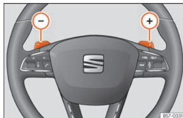
Fig. 247 Volante: palancas para cambio automático.
