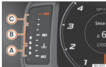
Fig. 63 Cuadro de instrumentos digital: indicador de temperatura del líquido refrigerante del motor.
