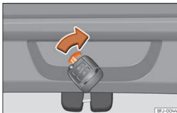
Fig. 88 Detalle del maletero: desbloqueo de emergencia.
