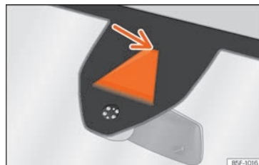
Fig. 270 En el parabrisas: área de campo visual del sistema de aviso de salida del carril.
