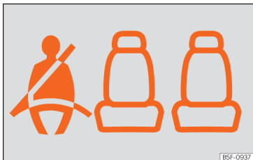
Fig. 6 Cuadro de instrumentos: indicación de plaza posterior izquierda ocupada y abrochado el cinturón correspondiente.
