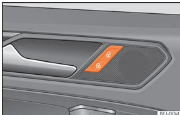
Fig. 76 Puerta del conductor: conmutador del cierre centralizado.
