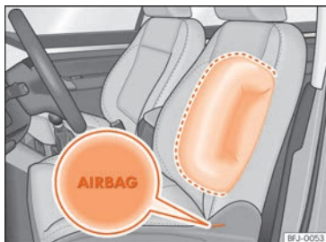
Fig. 22 Airbag lateral en el asiento del conductor.
