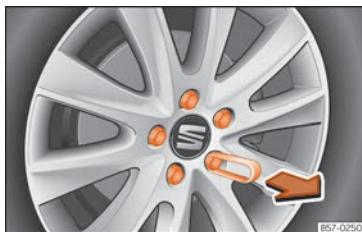
Fig. 36 Rueda: tornillos de la rueda con capuchones.
