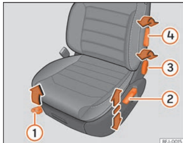
Fig. 107 Asientos delanteros: ajuste manual del asiento.
