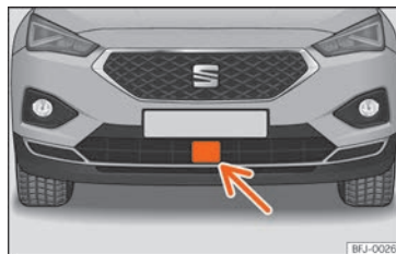
Fig. 258 En el paragolpes delantero: sensor de radar.
