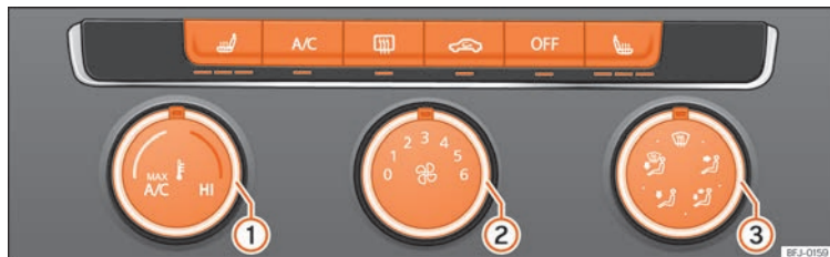
Fig. 154 En la consola central: mandos del aire acondicionado manual.
