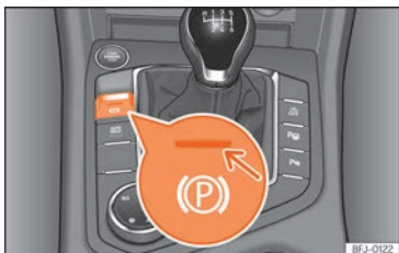
Fig. 278 En la parte inferior de la consola central: tecla del freno de estacionamiento electrónico.
