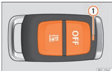
Fig. 159 Calefacción independiente: mando a distancia por radiofrecuencia.
