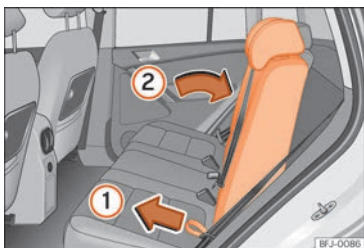
Fig. 110 Ajuste del respaldo del asiento trasero.
