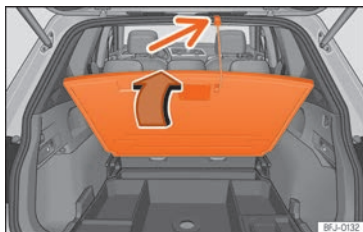
Fig. 128 En el maletero: levantar el suelo del maletero.
