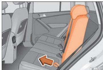
Fig. 119 Abatir y levantar el respaldo del asiento trasero.
