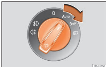
Fig. 94 Tablero de instrumentos: mando de las luces.
