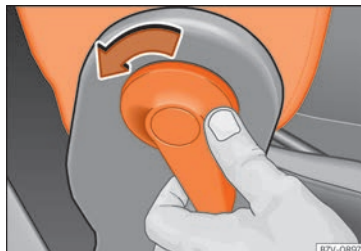
Fig. 118 Desbloquear el respaldo abatible del asiento del acompañante.
