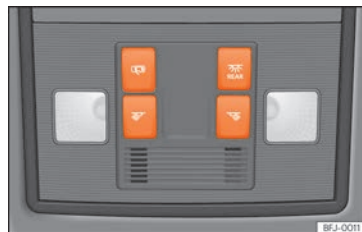
Fig. 100 Detalle del revestimiento del techo: iluminación delantera del habitáculo.
