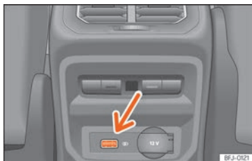
Fig. 237 Parte posterior consola central: conectores USB.
