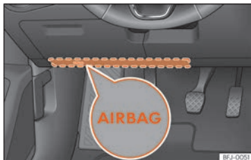
Fig. 20 En el lado del conductor: ubicación del airbag para las rodillas.
