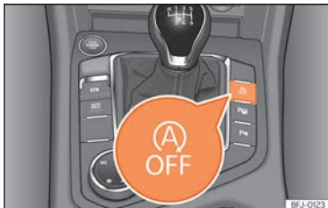
Fig. 243 Consola central: tecla del sistema Start-Stop.
