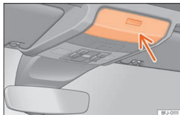
Fig. 143 En la consola del techo: estuche para gafas.
