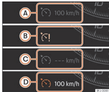
Fig. 251 Pantalla del cuadro de instrumentos: indicaciones de estado del GRA.
