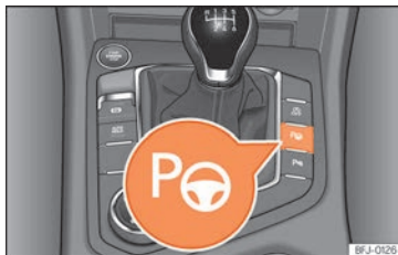
Fig. 281 En la parte superior de la consola central: tecla para conectar el sistema de aparcamiento asistido.
