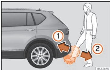
Fig. 87 Portón del maletero con apertura controlada por sensor (Easy Open).
