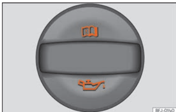
Fig. 312 Tapón de la boca de llenado de aceite del motor en el vano motor.
