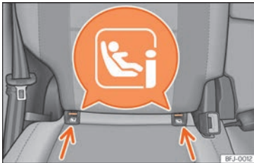
Fig. 28 Asientos laterales de la segunda fila: anillas de sujeción ISOFIX/i-Size.
