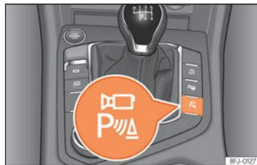
Fig. 294 Consola central: tecla para activar/desactivar manualmente el sistema de visión periférica cuando está en combinación con el sistema de aparcamiento asistido.
