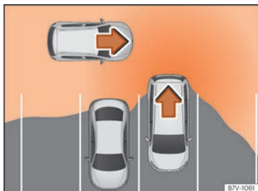
Fig. 277 Representación esquemática del asistente de desaparcamiento: zona vigilada alrededor del vehículo que está desaparcando.
