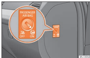
Fig. 18 Conmutador con llave para activar y desactivar el airbag del acompañante.
