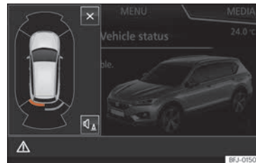
Fig. 289 Indicación en miniatura de la activación automática
