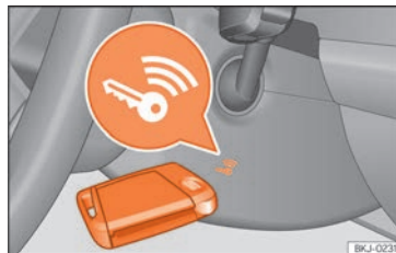
Fig. 241 A la derecha de la columna de dirección: arranque de emergencia.
