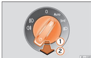
Fig. 95 Tablero de instrumentos: mando de las luces.
