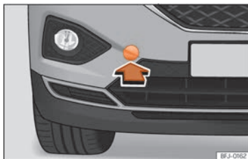
Fig. 48 En el lado derecho del paragolpes delantero: retirar la tapa.
