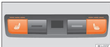
Fig. 158 En la parte trasera de la consola central: mandos para la calefacción de los asientos traseros.
