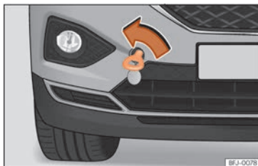
Fig. 49 En el lado derecho del paragolpes delantero: argolla de remolque enroscada.
