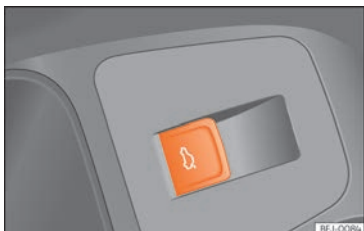
Fig. 86 En la puerta del conductor: tecla para abrir y cerrar el portón trasero.
