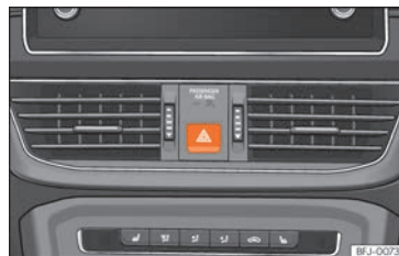
Fig. 98 Tablero de instrumentos: conmutador de los intermitentes de emergencia. »
