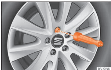
Fig. 42 Cambio de rueda: desenroscar los tornillos de rueda con el mango del destornillador.
