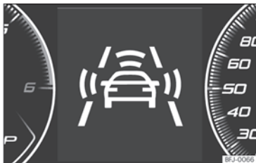
Fig. 257 En la pantalla del cuadro de instrumentos: indicaciones de preaviso.
