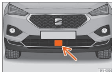
Fig. 264 En el paragolpes delantero: sensor de radar.
