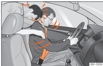
Fig. 21 El ocupante del asiento trasero que no lleve puesto el cinturón de seguridad se verá proyectado hacia adelante sobre el conductor que sí lleva el cinturón.
