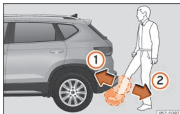
Fig. 59 Portón del maletero con apertura controlada por sensor (Easy Open).
