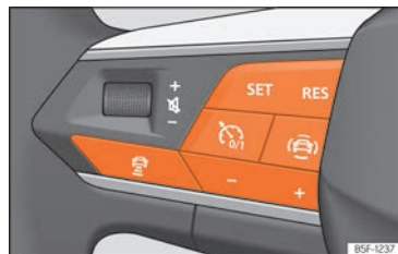
Fig. 115 En el volante multifunción: botones para manejar el ACC.
