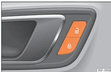
Fig. 51 En la puerta del conductor: botón del cierre centralizado.
