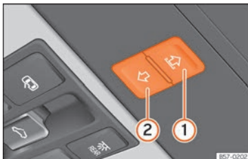
Fig. 65 En el revestimiento interior del techo: botón de función para manejar la cortinilla parasol.
