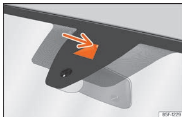
Fig. 107 En el parabrisas: área de campo visual del sistema de aviso de salida del carril.
