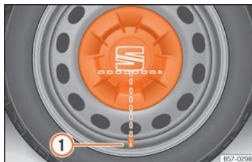
Fig. 223 Colocación correcta del embellecedor central de rueda para llantas de acero.
