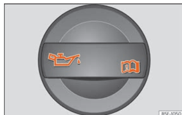
Fig. 216 Tapa de la boca de llenado de aceite del motor en el vano motor.
