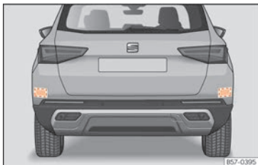
Fig. 108 Vista trasera del vehículo: zonas de los sensores de radar.
