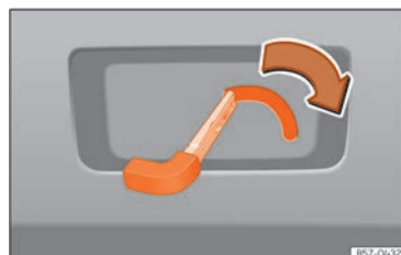
Fig. 61 Detalle del maletero: desbloqueo de emergencia.
