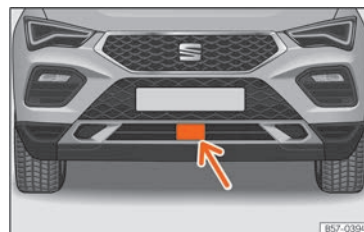
Fig. 105 En el paragolpes delantero: sensor de radar.
