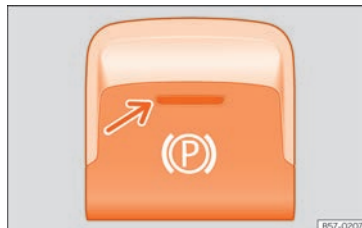
Fig. 131 En la parte inferior de la consola central: tecla del freno de estacionamiento electrónico.
