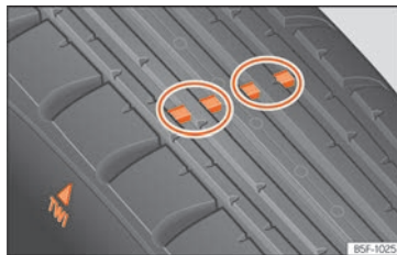
Fig. 219 Perfil del neumático: indicadores de desgaste.
