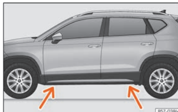
Fig. 228 Puntos de apoyo del gato.
