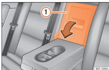
Fig. 178 En el respaldo del asiento trasero: apertura de la trampilla.
