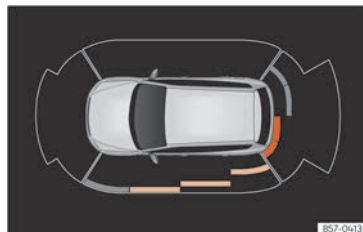
Fig. 136 Visualización de ayuda al aparcamiento en la pantalla del sistema de infotainment.
