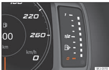
Fig. 4 Cuadro de instrumentos SEAT Digital Cockpit: indicador del nivel de combustible.
