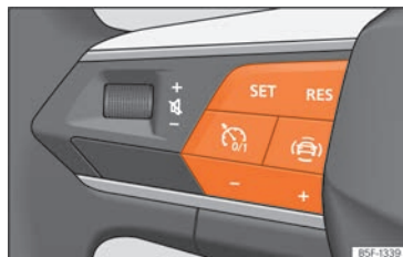
Fig. 112 En el volante multifunción: botones para manejar el limitador de velocidad.
