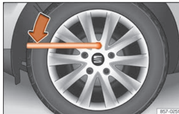
Fig. 226 Cambio de rueda: aflojar los tornillos de rueda.
