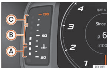
Fig. 6 Cuadro de instrumentos digital SEAT Digital Cockpit: indicador de temperatura del líquido refrigerante del motor.
