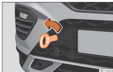
Fig. 198 Parte derecha del parachoques delantero: argolla de remolque enroscada.
