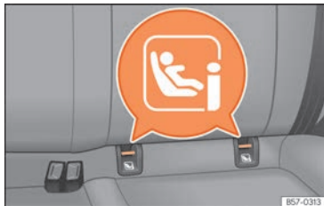
Fig. 36 Asiento trasero: ubicación de las anillas de sujeción ISOFIX o i-Size.
