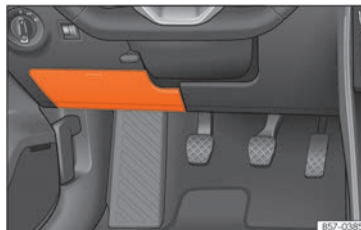
Fig. 201 En el tablero de instrumentos del lado del conductor: tapa de la caja de fusibles.
