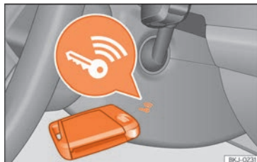
Fig. 95 A la derecha de la columna de dirección: arranque de emergencia.
