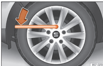
Fig. 196 Cambio de rueda: aflojar los tornillos de rueda.
