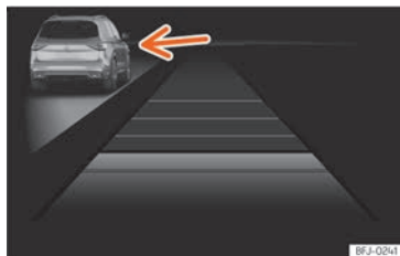
Fig. 103 En la pantalla del cuadro de instrumentos: ACC activo, vehículo detectado por la izquierda.
