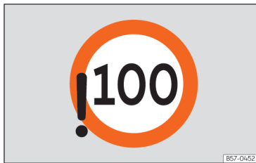
Fig. 9 En la pantalla del cuadro de instrumentos: detectada infracción de la velocidad máxima permitida (ilustración).
