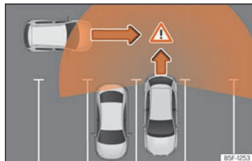
Fig. 130 Representación esquemática del asistente de desaparcamiento: zona vigilada alrededor del vehículo que está desaparcando.
