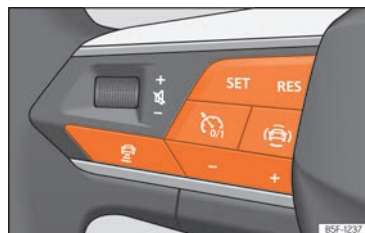
Fig. 102 En el volante multifunción: botones para manejar el ACC.
