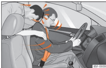
Fig. 20 El ocupante del asiento trasero que no lleve puesto el cinturón de seguridad se verá proyectado hacia delante sobre el conductor que sí lleva el cinturón.
