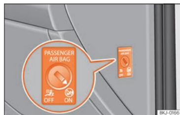
Fig. 27 Conmutador con llave para activar y desactivar el airbag del acompañante.
