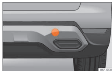
Fig. 166 En el lado derecho del paragolpes trasero: retirar la tapa.
