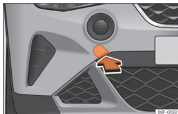
Fig. 164 En el lado derecho del paragolpes delantero: retirar la tapa.
