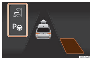
Fig. 124 En la pantalla del cuadro de instrumentos: visualización del sistema de aparcamiento asistido con visualización reducida.
