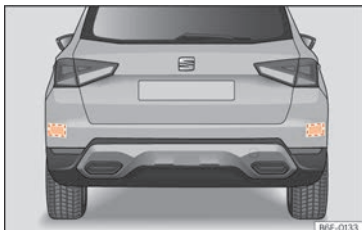
Fig. 95 Vista trasera del vehículo: zonas de los sensores de radar.
