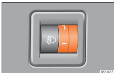
Fig. 70 Al lado del volante: regulador del alcance de las luces.
