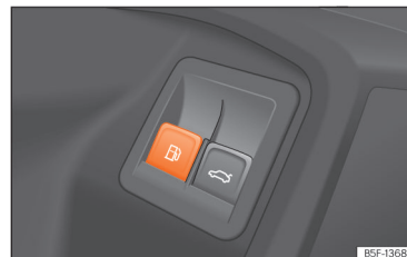
Fig. 203 Porta del conductor: desbloqueig de la tapa del dipòsit.
