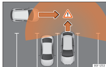
Fig. 157 Representació esquemàtica de l'assistent de sortida de l'aparcament: zona vigilada al voltant del vehicle que està sortint de l'aparcament.
