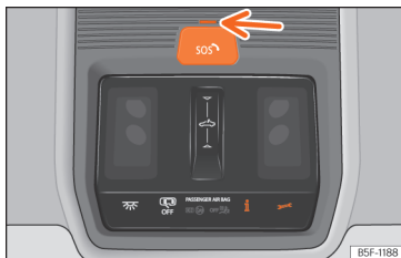
Fig. 53 A la consola del sostre: comandaments per als serveis de veu.
