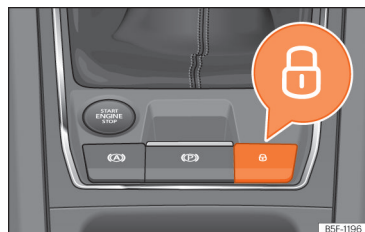
Fig. 74 A la consola central: commutador del tancament centralitzat
