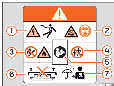
Fig. 56 Rètol d'avertiment a la bateria d'alt voltatge.
