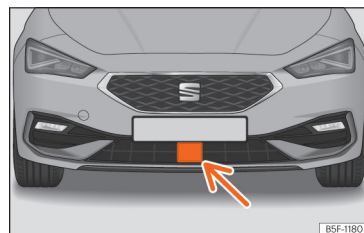
Fig. 123 Al para-xocs davanter: sensor de radar.
