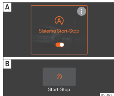
Fig. 117 A la pantalla del sistema d'Infotainment: sistema Start-Stop connectat. A) Vista al menú principal. B) Vista amb el sistema d'Infotainment apagat.
