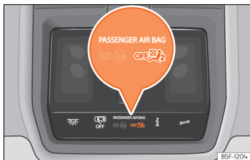
Fig. 33 A la consola del sostre: indicador de control de la desactivació del coixí de seguretat de l'acompanyant.
