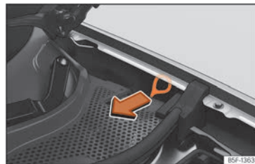
Fig. 218 Entre la aleta izquierda y la bisagra del capó del motor: Tirador para el desbloqueo manual de emergencia del conector de carga.
