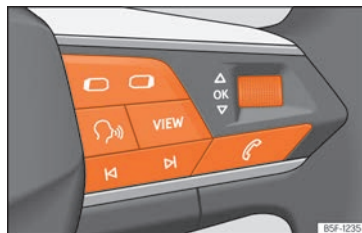
Fig. 72 Lado derecho del volante multifunción: teclas para utilizar los menús y las indicaciones informativas del cuadro de instrumentos.
