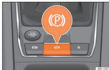
Fig. 198 En la parte inferior de la consola central: tecla del freno de estacionamiento electrónico.
