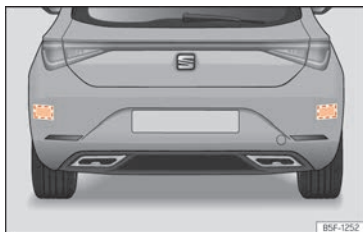
Fig. 174 Vista trasera del vehículo: zonas de los sensores de radar.
