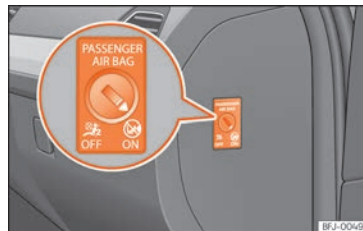
Fig. 20 Conmutador con llave para activar y desactivar el airbag del acompañante.
