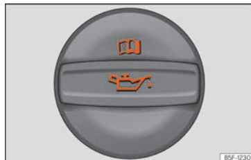
Fig. 233 Tapón de la boca de llenado de aceite del motor en el vano motor.
