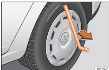
Fig. 41 Retirar el embellecedor integral.
