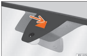
Fig. 173 En el parabrisas: área de campo visual del sistema de aviso de salida del carril.
