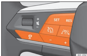
Fig. 190 Lado izquierdo del volante multifunción: teclas para el manejo del Travel Assist.
