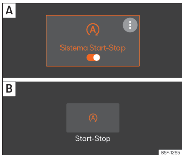
Fig. 167 En la pantalla del sistema de infotainment: sistema Start-Stop conectado. A Vista en el menú principal. B Vista con el sistema de infotainment apagado.
