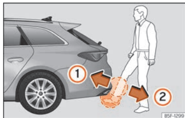
Fig. 97 Portón del maletero con apertura controlada por sensor (Easy Open).
