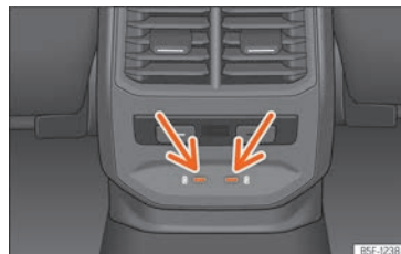
Fig. 164 Parte posterior consola central: conectores USB con función de toma de corriente.
