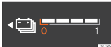
Fig. 67 Cuadro de instrumentos digital: indicador del nivel de batería.
