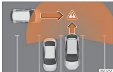
Fig. 195 Representación esquemática del asistente de desaparcamiento: zona vigilada alrededor del vehículo que está desaparcando.
