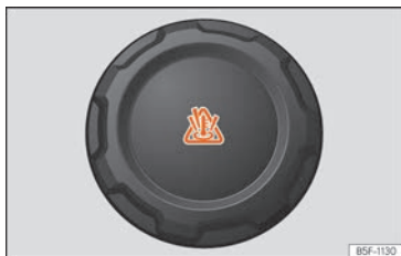
Fig. 236 Vano motor: tapón del depósito de expansión del líquido refrigerante.
