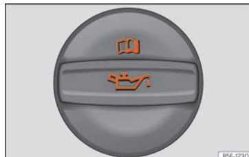
Fig. 231 Tapón de la boca de llenado de aceite del motor en el vano motor.
