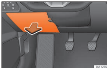
Fig. 55 En el tablero de instrumentos del lado del conductor: tapa de la caja de fusibles.
