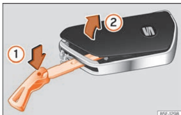
Fig. 84 Llave del vehículo: abrir la tapa del compartimento de la pila.
