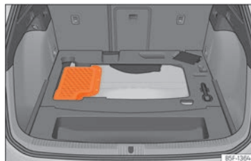
Fig. 237 Vehículos híbridos (PHEV): ubicación de la batería en el maletero
