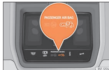
Fig. 21 En la consola del techo: testigo de control de la desactivación del airbag del acompañante.
