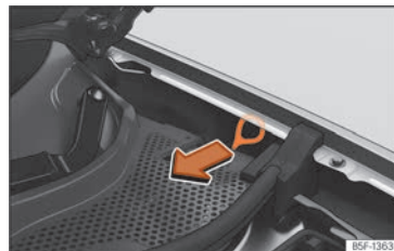
Fig. 216 Entre la aleta izquierda y la bisagra del capó del motor: Tirador para el desbloqueo manual de emergencia del conector de carga.
