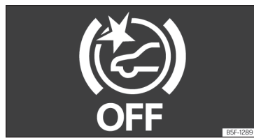
Fig. 179 En la pantalla del cuadro de instrumentos: indicación de Front Assist desactivado.
