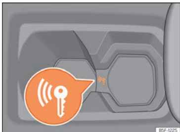
Fig. 164 En la consola central: arranque de emergencia.
