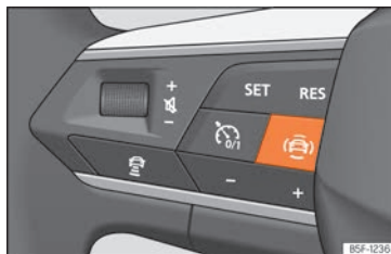
Fig. 73 Lado izquierdo del volante multifunción: tecla para los sistemas de asistencia al conductor (según versiones).
