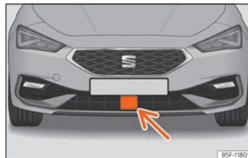
Fig. 169 En el paragolpes delantero: sensor de radar.
