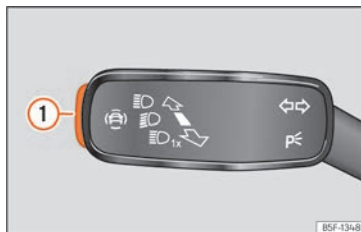
Fig. 72 En la palanca de intermitentes y de luz de carretera: tecla para los sistemas de asistencia al conductor (según versiones).
