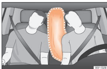
Fig. 25 Airbag central completamente inflado (zona de despliegue).
