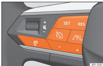
Fig. 188 Lado izquierdo del volante multifunción: teclas para el manejo del Travel Assist.
