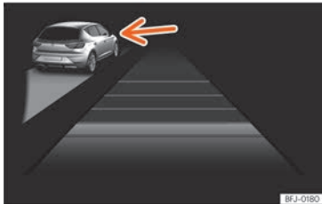
Fig. 182 En la pantalla del cuadro de instrumentos: ACC activo, vehículo detectado por la izquierda
