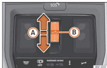
Fig. 100 En el revestimiento interior del techo: tecla del techo de cristal.
