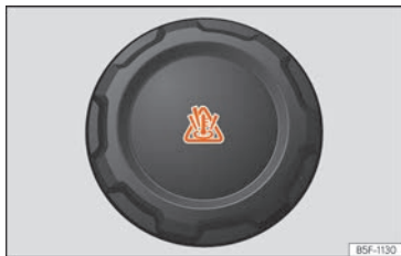
Fig. 234 Vano motor: tapón del depósito de expansión del líquido refrigerante.
