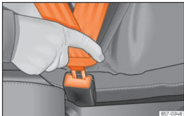
Fig. 14 Insertar la lengüeta del cinturón de seguridad en su cierre.
