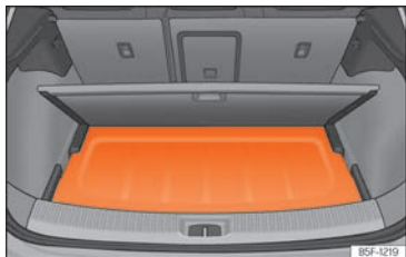
Fig. 125 En el maletero: colocación de la bandeja.
