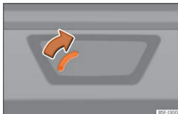
Fig. 98 Detalle del maletero: desbloqueo de emergencia (Leon Sportstourer).
