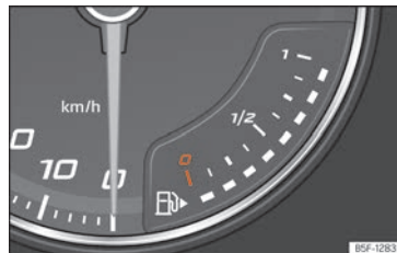
Fig. 67 Cuadro de instrumentos analógico: indicador de nivel de combustible
