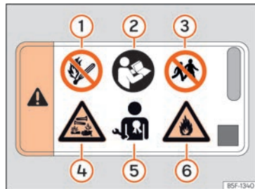
Fig. 239 Batería de 48 voltios: advertencia de peligros
