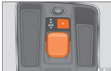
Fig. 167 En la consola central: mando selector.
