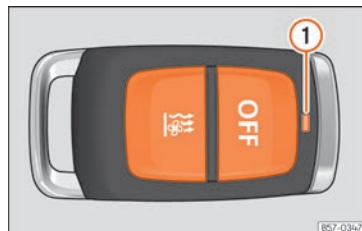
Fig. 153 Calefacción independiente: mando a distancia por radiofrecuencia.
