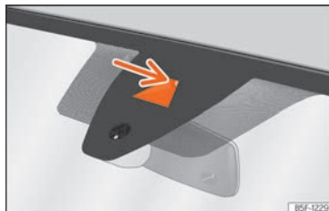
Fig. 171 En el parabrisas: área de campo visual del sistema de aviso de salida del carril.
