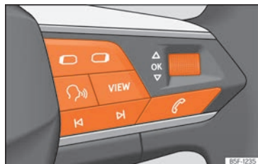
Fig. 71 Lado derecho del volante multifunción: teclas para utilizar los menús y las indicaciones informativas del cuadro de instrumentos.
