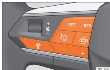
Fig. 180 En el volante multifunción: botones para manejar el ACC
