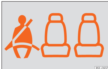
Fig. 10 Cuadro de instrumentos: indicación de plaza posterior izquierda ocupada y abrochado el cinturón correspondiente.
