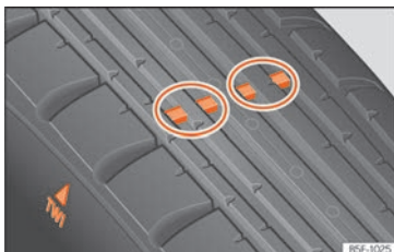
Fig. 241 Perfil del neumático: indicadores de desgaste.
