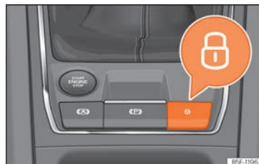
Fig. 87 En consola central: conmutador del cierre centralizado
