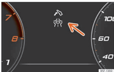
Fig. 64 Indicación de la asistencia para una conducción ecoeficiente (representación esquemática).
