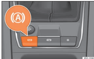
Fig. 197 En la parte inferior de la consola central: tecla de la función Auto Hold.
