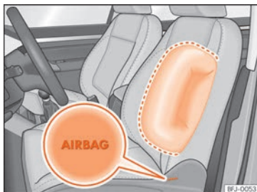
Fig. 26 Airbag lateral en el asiento del conductor.
