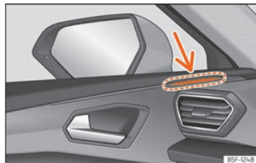
Fig. 189 Testigo de control del asistente de cambio de carril.
