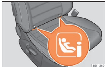
Fig. 33 Asiento pasajero delantero: anillas de sujeción ISO-FIX/i-Size.
