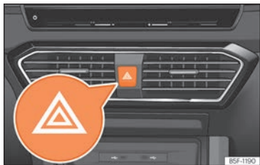
Fig. 104 Tablero de instrumentos: conmutador de los intermitentes de emergencia.
