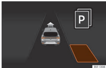
Fig. 198 En la pantalla del cuadro de instrumentos: visualización del sistema de aparcamiento asistido con visualización reducida.
