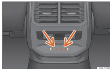
Fig. 162 Parte posterior consola central: conectores USB con función de toma de corriente.
