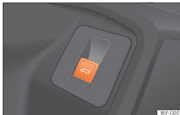
Fig. 95 En la puerta del conductor: tecla para abrir y cerrar el portón trasero.
