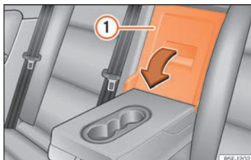
Fig. 137 En el respaldo del asiento trasero: apertura de la trampilla.
