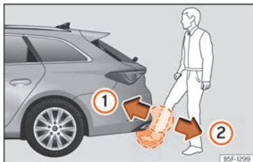
Fig. 96 Portón del maletero con apertura controlada por sensor [Easy Open].
