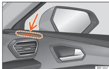
Fig. 190 Testigo de control del asistente de cambio de carril.
