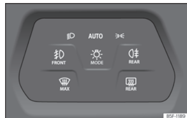
Fig. 102 Tablero de instrumentos: mando de las luces.
