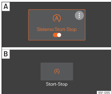
Fig. 149 En la pantalla del sistema de Infotainment: sistema Start-Stop conectado. A Vista en el menú principal. B Vista con el sistema de Infotainment apagado.
