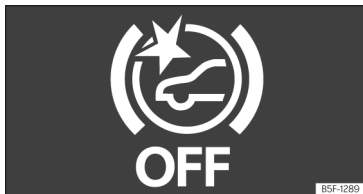
Fig. 160 En la pantalla del cuadro de instrumentos: indicación de Front Assist desactivado.
