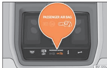
Fig. 18 En la consola del techo: testigo de control de la desactivación del airbag del acompañante.
