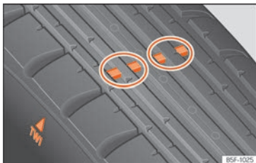
Fig. 210 Perfil del neumático: indicadores de desgaste.
