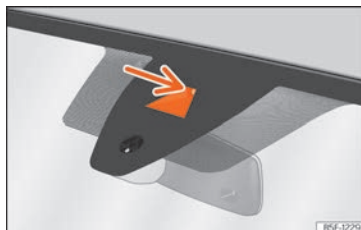
Fig. 169 En el parabrisas: área de campo visual del sistema de aviso de salida del carril.
