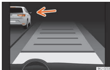
Fig. 166 En la pantalla del cuadro de instrumentos: ACC activo, vehículo detectado por la izquierda
