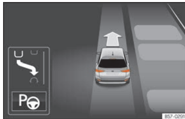
Fig. 184 En la pantalla del cuadro de instrumentos: visualización del sistema de aparcamiento asistido con visualización reducida.
