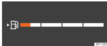
Fig. 59 Cuadro de instrumentos digital: indicador del nivel de combustible localizado en diferentes posiciones en función de la vista.
