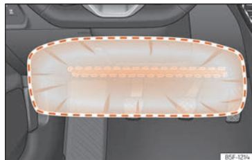
Fig. 20 En el lado del conductor: radio de acción del airbag para las rodillas.
