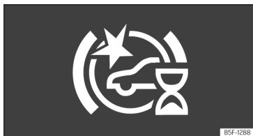
Fig. 159 En la pantalla del cuadro de instrumentos: indicación de autocalibración inicial del sistema.
