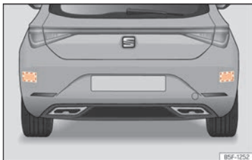
Fig. 176 Vista trasera del vehículo: zonas de los sensores de radar.
