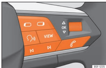
Fig. 62 Lado derecho del volante multifunción: teclas para utilizar los menús y las indicaciones informativas del cuadro de instrumentos.
