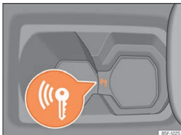
Fig. 148 En la consola central: arranque de emergencia.
