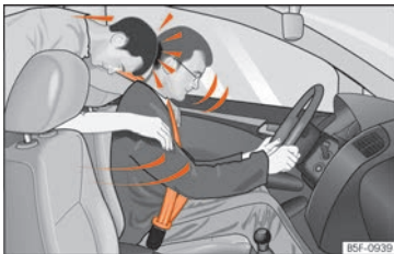
Fig. 10 El ocupante del asiento trasero que no lleve puesto el cinturón de seguridad se verá lanzado hacia delante sobre el conductor que sí lleva el cinturón.
