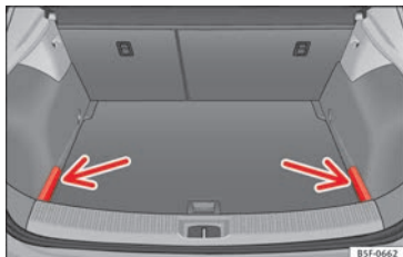
Fig. 163 En el maletero: tapas para guardar la bandeja portaobjetos.
