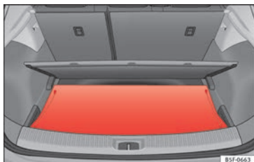
Fig. 164 En el maletero: colocación de la bandeja portaobjetos.
