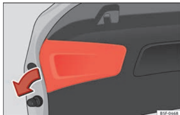
Fig. 115 Retirar la cubierta del portón del maletero
