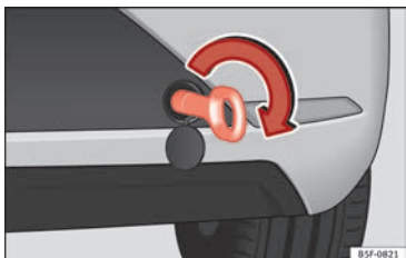
Fig. 76 Parte derecha del parachoques trasero: argolla de remolque enroscada.
