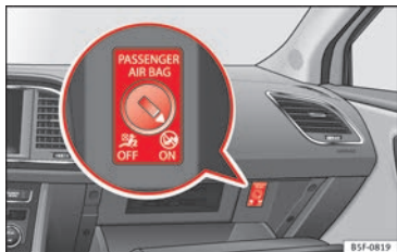
Fig. 22 Conmutador del airbag frontal del acompañante.
