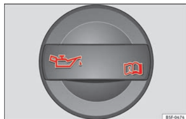
Fig. 60 Tapón de la boca de llenado de aceite del motor en el vano motor.
