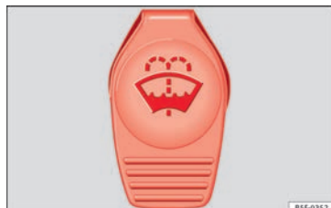
Fig. 63 En el vano motor: tapón del depósito del limpiacristales.
