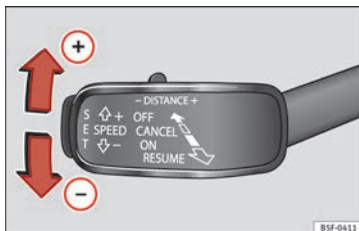
Fig. 201 A la izquierda de la columna de la dirección: tercera palanca para manejar el control adaptativo de velocidad.
