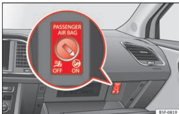
Fig. 94 Conmutador del airbag frontal del acompañante.
