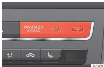
Fig. 95 Testigo para desconexión de airbag del acompañante.
