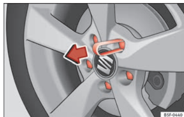
Fig. 70 Rueda: tornillos de la rueda con capuchones.
