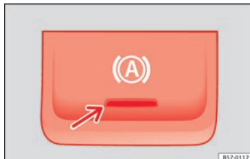
Fig. 195 En la parte inferior de la consola central: tecla de la función Auto Hold.
