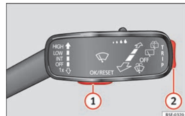
Fig. 42 Palanca del limpiaparabrisas: teclas de control.
