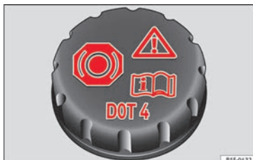
Fig. 62 Vano motor: tapón del depósito del líquido de frenos.
