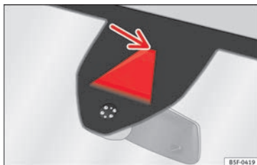
Fig. 214 En el parabrisas: área de campo visual del sistema de aviso de salida del carril.
