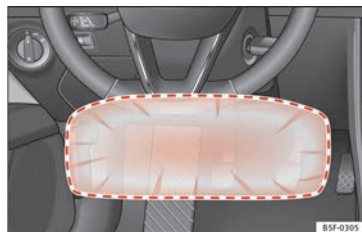
Fig. 24 En el lado del conductor: radio de acción del airbag para las rodillas.
