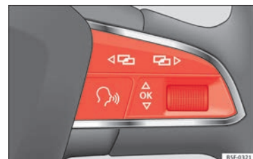
Fig. 43 Lado derecho del volante multifunción: teclas de control.
