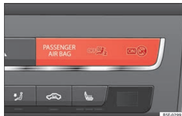
Fig. 93 Testigo de control en el tablero de instrumentos para la desactivación del airbag frontal del acompañante.
