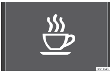
Fig. 218 En la pantalla del cuadro de instrumentos: símbolo de detección de cansancio.
