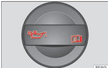
Fig. 242 Tapón de la boca de llenado de aceite del motor en el vano motor.
