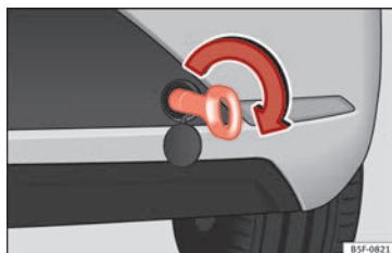
Fig. 99 Parte derecha del parachoques trasero: argolla de remolque enroscada.
