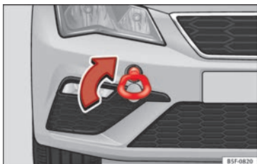
Fig. 97 Parte derecha del parachoques delantero: argolla de remolque enroscada.
