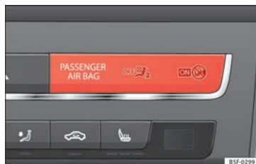
Fig. 51 Testigo para desconexión de airbag del acompañante.
