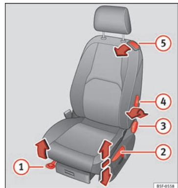
Fig. 13 Asientos delanteros: ajuste manual del asiento.
