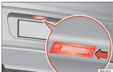
Fig. 117 En el parachoques posterior: luz de matrícula.
