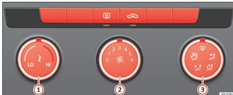
Fig. 57 En la consola central: mandos del sistema de calefacción y aire fresco.
