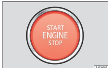
Fig. 187 En la parte inferior de la consola central: pulsador de arranque. »
