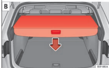
Fig. 161 En el maletero: desenrollar y enrollar la bandeja portaobjetos.
