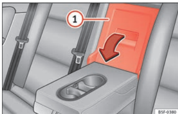
Fig. 171 En el respaldo del asiento trasero: apertura de la trampilla.
