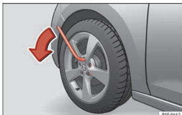
Fig. 72 Rueda: aflojar los tornillos de rueda.
