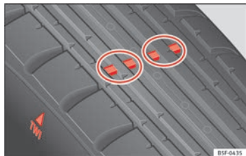
Fig. 166 Perfil del neumático: indicadores de desgaste.
