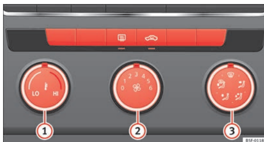
Fig. 118 En la consola central: mandos del sistema de calefacción y aire fresco.
