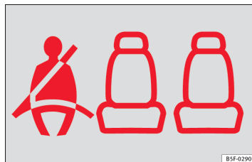
Fig. 6 Cuadro de instrumentos: indicación de plaza posterior derecha ocupada y abrochado el cinturón correspondiente.
