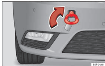
Fig. 178 Parte derecha del parachoques delantero: argolla de remolque enroscada.
