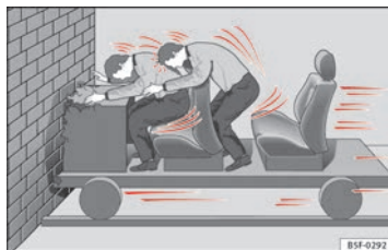
Fig. 8 El vehículo choca con el muro: los ocupantes no llevan abrochado el cinturón.
