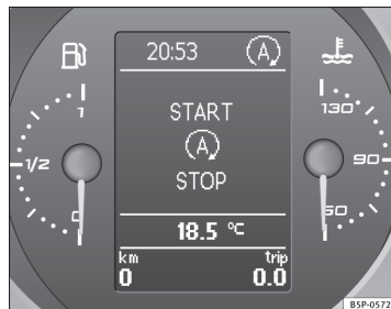
Fig. 120 Indicación en la pantalla del cuadro de instrumentos durante el funcionamiento Start-Stop.
