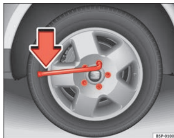
Fig. 156 Cambio de rueda: aflojar los tornillos de rueda
