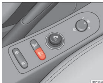
Fig. 50 Consola central: tecla del sistema de control de los neumáticos
