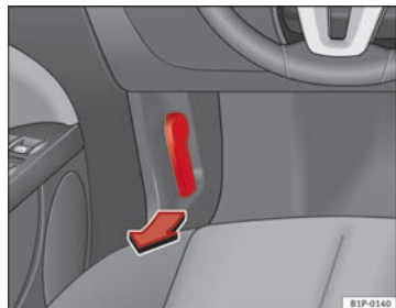
Fig. 142 Detalle de la zona reposapiés del lado del conductor: palanca para el desbloqueo del capó del motor.
