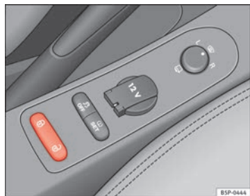
Fig. 57 Detalle de la consola central: pulsador del cierre centralizado
