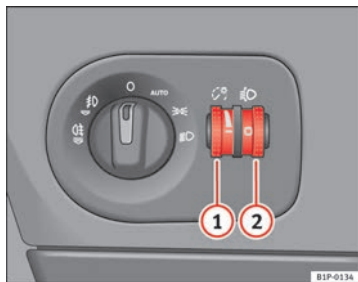
Fig. 73 Tablero de instrumentos: reguladores de la iluminación de instrumentos y mandos y del alcance de los faros
