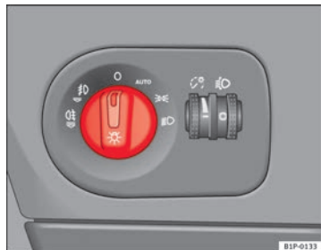
Fig. 72 Encendido automático de luces
