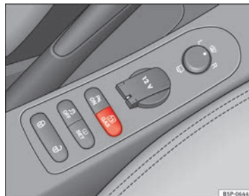
Fig. 118 Consola central: conmutador de control del sistema de gas.
