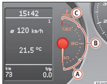
Fig. 34 Cuadro de instrumentos: indicador de la temperatura del líquido refrigerante del motor
