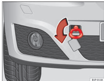
Fig. 182 Atornillado de la argolla de remolque en la parte delantera derecha del vehículo
