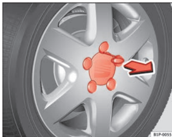
Fig. 155 Cambio de rueda: Retirar el embellecedor de la rueda
