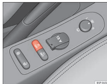
Fig. 116 Detalle de la consola central: tecla ESC (ESP)
