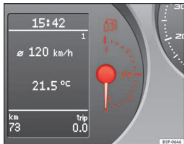
Fig. 35 Cuadro de instrumentos: indicador del nivel de gas.
