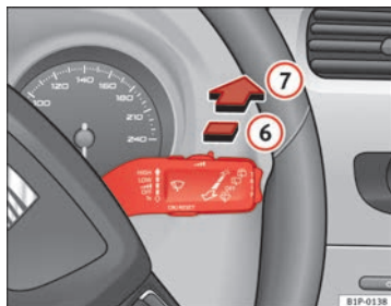
Fig. 84 Palanca del limpiacristal: limpia-lavaluneta
