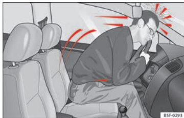
Fig. 80 El conductor que no lleve puesto el cinturón de seguridad se verá lanzado hacia delante.
