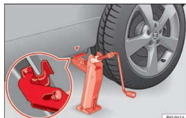
Fig. 66 Colocación del gato.
