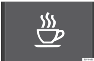
Fig. 163 En la pantalla del cuadro de instrumentos: símbolo de detección de cansancio.
