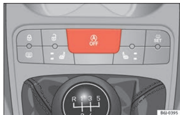
Fig. 162 Detalle del pulsador del funcionamiento Start-Stop.
