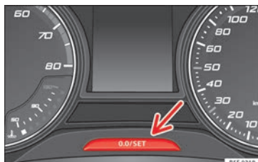
Fig. 114 Cuadro de instrumentos: cuentakilómetros y tecla de puesta a cero.
