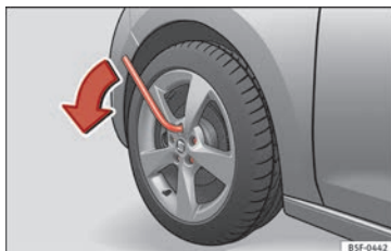
Fig. 64 Rueda: aflojar los tornillos de rueda.
