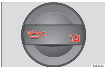
Fig. 52 Tapón de la boca de llenado de aceite del motor en el vano motor.
