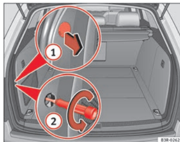
Fig. 224 Maletero: Posición del tornillo de fijación para la unidad de luz trasera
