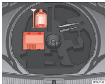
Fig. 191 Juego para reparación de neumáticos (tire mobility system) debajo de la superficie de carga del maletero
