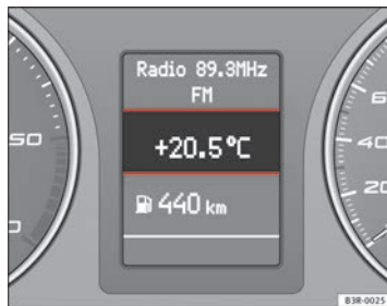
Fig. 49 Pantalla: Indicador de temperatura exterior
