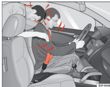
Fig. 9 El ocupante del asiento trasero que no lleve puesto el cinturón de seguridad se verá lanzado hacia adelante sobre el conductor que sí lleva el cinturón.
