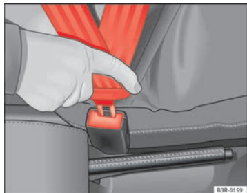
Fig. 11 Cierre y lengüeta del cinturón de seguridad
