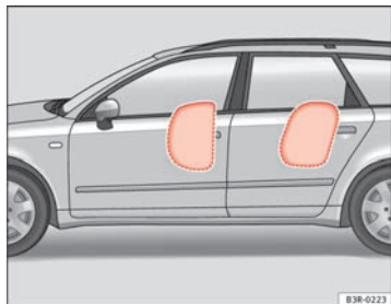
Fig. 24 Airbag lateral inflado en el lado izquierdo del vehículo
