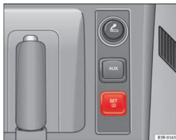
Fig. 186 Detalle de la consola central: Tecla del indicador de la presión de los neumáticos
