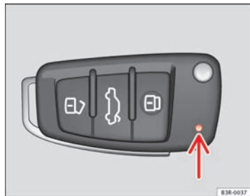
Fig. 68 Diodo luminoso en la llave de control remoto
