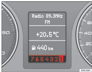
Fig. 158 Pantalla: Cambiar las marchas manualmente (modo tiptronic)
