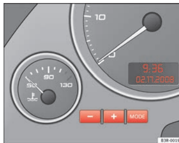
Fig. 40 Detalle del cuadro de instrumentos: Reloj digital
