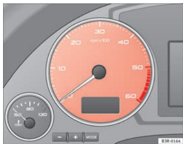
Fig. 39 Detalle del cuadro de instrumentos. Cuentarrevoluciones
