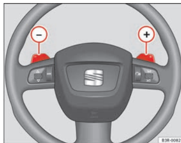
Fig. 159 Volante: Mandos del tiptronic
