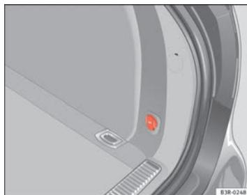
Fig. 136 Detalle del revestimiento lateral del maletero: Toma de corriente de 12 voltios
