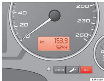
Fig. 42 Detalle del cuadro de instrumentos: Cuentakilómetros
