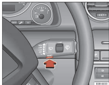
Fig. 61 Palanca del limpiaparabrisas: Tecla de manejo para seleccionar menús
