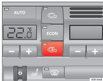
Fig. 142 Tecla para la recirculación de aire automática
