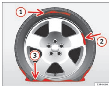
Fig. 198 Pinchazos para los que no se adecua el sistema tire mobility system
