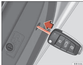
Fig. 73 Activar el bloqueo de emergencia
