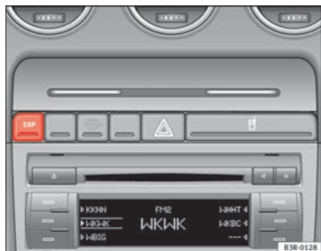
Fig. 146 Detalle de la consola central: tecla ESP
