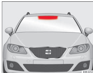
Fig. 173 Área de ubicación del telepeaje
