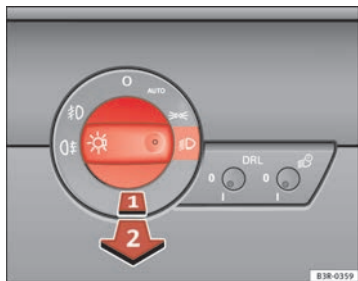
Fig. 85 Detalle del tablero de instrumentos: Comutador de las luces
