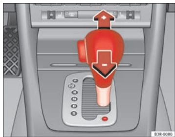
Fig. 157 Consola central: Cambiar las marchas manualmente (modo tiptronic)
