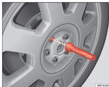
Fig. 196 Cambio de rueda: Útil de hexágono interior para girar los tornillos
