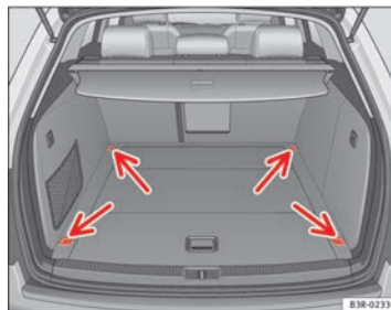
Fig. 117 Disposición de las argollas de amarre en el maletero
