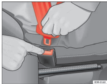
Fig. 15 Retirar la lengüeta del cierre del cinturón
