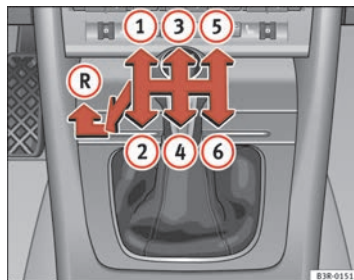
Fig. 153 Detalle de la consola central: esquema de un cambio manual de 6 marchas
