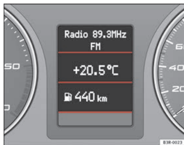
Fig. 47 Puesto de conducción: Pantalla digital del cuadro de instrumentos
