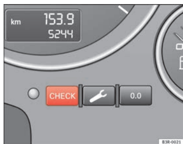
Fig. 53 Cuadro de instrumentos: Tecla CHECK
