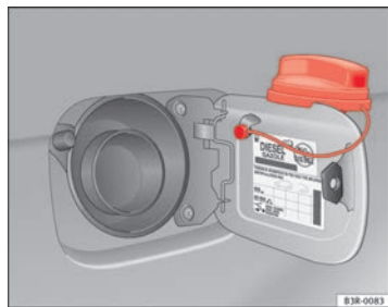
Fig. 174 Tapa del depósito con el tapón encajado
