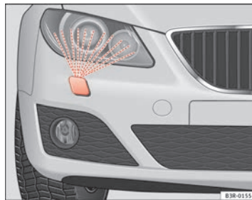
Fig. 103 Faro con inyector de lavado desplegado
