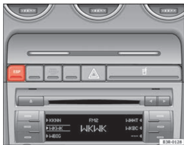
Fig. 160 Consola central con el interruptor del ESP
