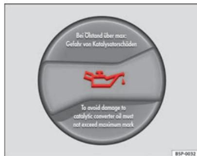
**Fig. 171** Tapón de la boca de llenado de aceite del motor en el vano motor
