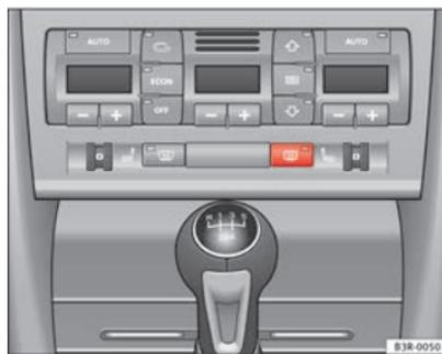
Fig. 96 Interruptor para luneta térmica
