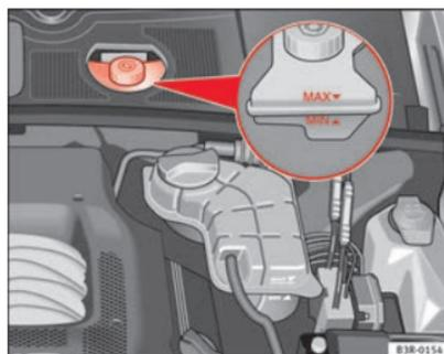
Fig. 176 Compartimento del motor: marcas en el depósito del líquido de frenos
