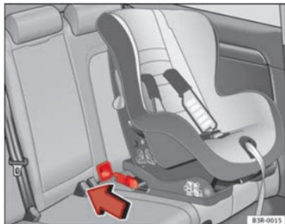
Fig. 34 Los anclajes ISOFIX del asiento infantil se deslizan por las guías de plástico ya montadas hasta fijarlos en los anclajes ISOFIX del vehículo
