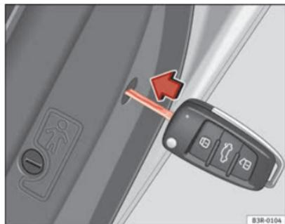
Fig. 74 Activar el bloqueo de emergencia
