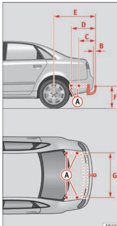
Fig. 165 Puntos de fijación del dispositivo de remolque
