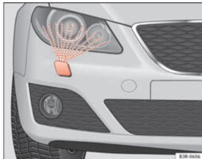
Fig. 101 Faro con eyector de lavado desplegado
