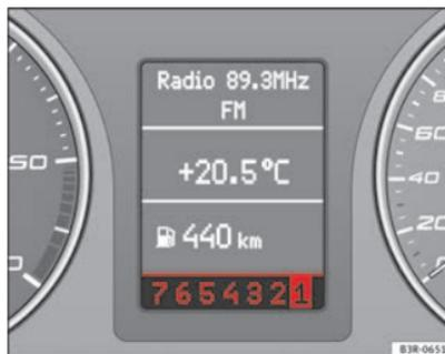
Fig. 151 Pantalla: Cambiar las marchas manualmente (modo tiptronic) ▶
