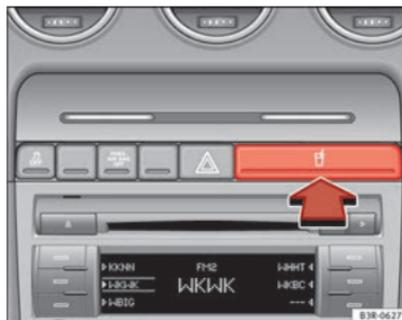
Fig. 119 Detalle del tablero de instrumentos: Portabebidas
