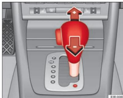
Fig. 150 Consola central: Cambiar las marchas manualmente (modo tiptronic)
