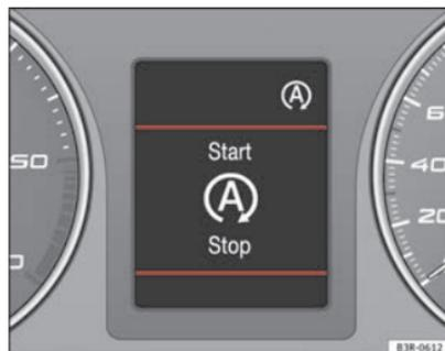
Fig. 138 Indicación en la pantalla del cuadro de instrumentos durante el funcionamiento Start-Stop.
