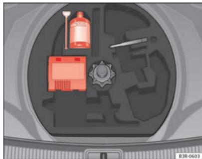
Fig. 181 Juego para reparación de neumáticos (tire mobility system) debajo de la superficie de carga del maletero
