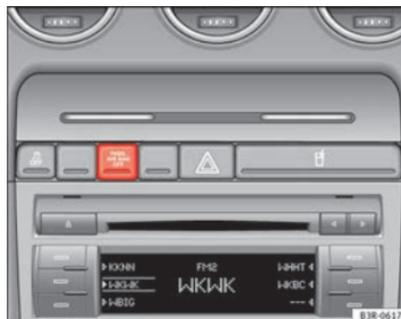
Fig. 29 Testigo de control de la desactivación del airbag del acompañante
