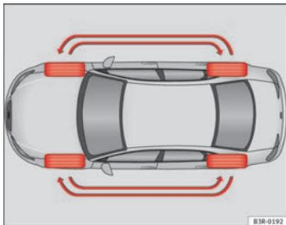
Fig. 179 Esquema para el cambio de ruedas
