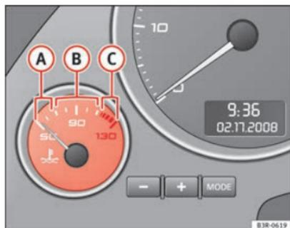
Fig. 39 Indicador de la temperatura del líquido refrigerante del motor
