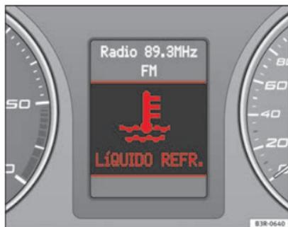
Fig. 55 Pantalla: Aviso sobre el nivel del líquido refrigerante
