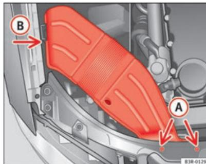
Fig. 192 Conducción de ventilación en el lado derecho del vehículo
