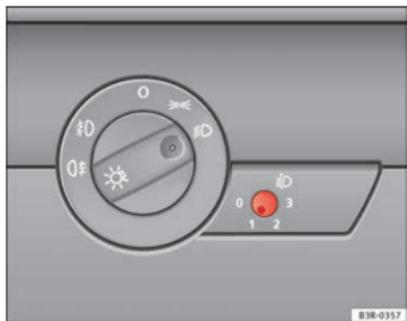
**Fig. 87** Regulación del alcance de las luces
