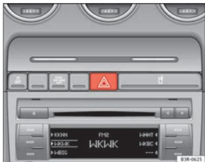
**Fig. 90 Consola central:** Interruptor para intermitentes simultáneos de emergencia
