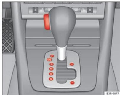
Fig. 147 Detalle de la consola central: Palanca selectora con tecla de bloqueo
