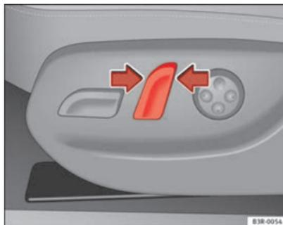
Fig. 107 Asiento delantero: Mando para la inclinación del respaldo
