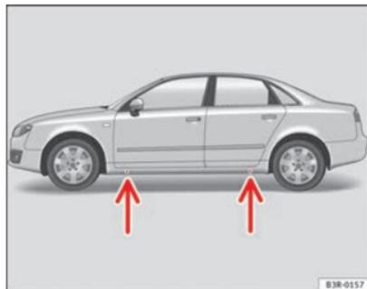
Fig. 184 Cambio de rueda: Puntos de apoyo del gato
