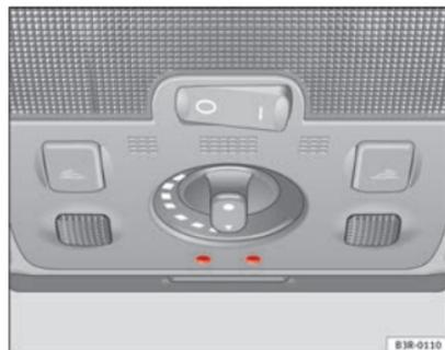
Fig. 93 Detalle del revestimiento del techo: Iluminación ambiental
