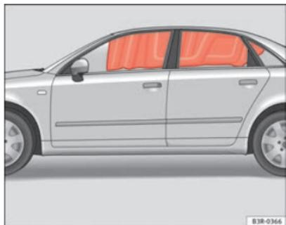
Fig. 27 Airbags para la cabeza inflados
