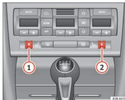
Fig. 132 Detalle del tablero de instrumentos: Ruedecillas moleteadas para la calefacción del asiento
