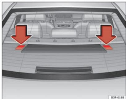
Fig. 35 Posición de las anillas Top Tether en la bandeja posterior
