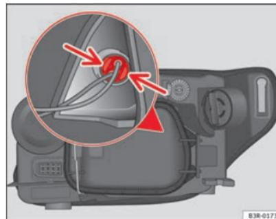
**Fig. 200 Luz de posición (lado exterior vehículo)**
