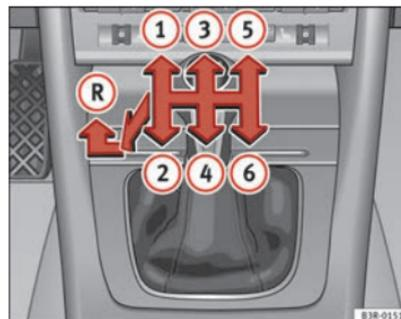
Fig. 146 Detalle de la consola central: esquema de un cambio manual de 6 marchas
