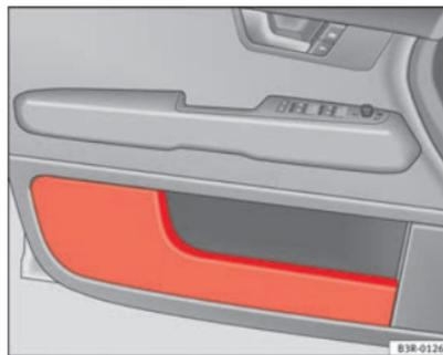
Fig. 127 Revestimiento de la puerta con portaobjetos
