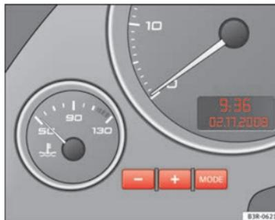
Fig. 41 Detalle del cuadro de instrumentos: Reloj digital
