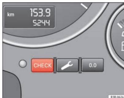
Fig. 58 Detalle del cuadro de instrumentos: Tecla CHECK
