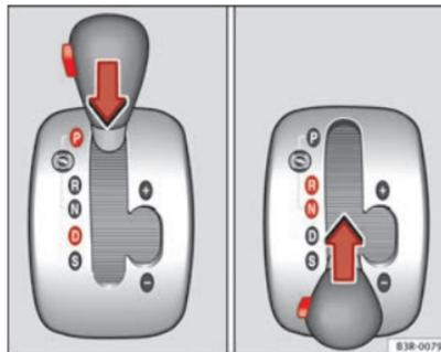
Fig. 149 Bloqueo de la palanca selectora
