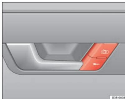
**Fig. 72** Detalle de la puerta del conductor: Conmutador del cierre centralizado
