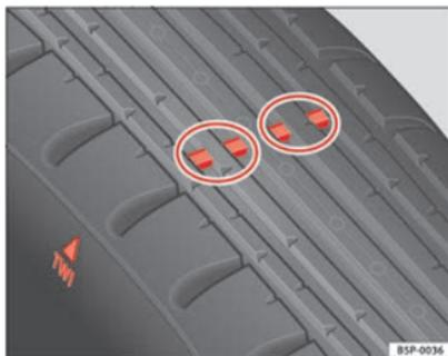
Fig. 178 Indicadores de desgaste del perfil del neumático
