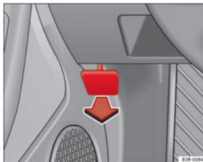
**Fig. 168** Detalle de la zona reposapiés del lado del conductor: palanca para el desbloqueo del capó del motor. ▶
