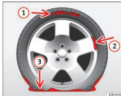
Fig. 187 Pinchazos para los que no se adecua el sistema tire mobility system
