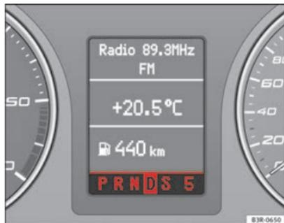
Fig. 148 Pantalla: Posiciones de la palanca selectora
