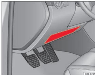
Fig. 22 Airbag de rodilla del conductor
