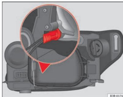
**Fig. 202 Luz de posición. Empuñadura del portalámparas en posición vertical**
