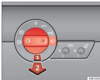
Fig. 83 Detalle del tablero de instrumentos: Conmutador de las luces
