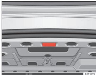
Fig. 95 Detalle de la parte superior del maletero: iluminación del maletero
