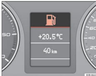
Fig. 56 Pantalla: Nivel de combustible bajo
