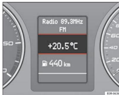
Fig. 50 Pantalla: Indicador de temperatura exterior
