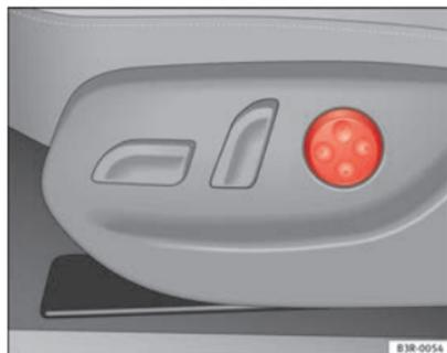
Fig. 108 Asiento delantero: Placa reguladora para apoyo lumbar
