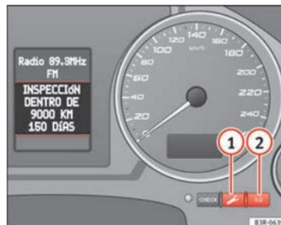
Fig. 53 Detalle del cuadro de instrumentos: Indicación de intervalo de servicio
