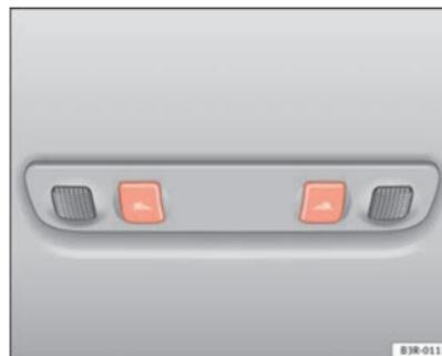
Fig. 94 Detalle del revestimiento del techo: Luces de lectura traseras
