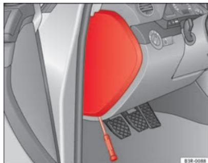
**Fig. 189** Tapa de la caja de fusibles en el lado izquierdo del tablero de instrumentos.
