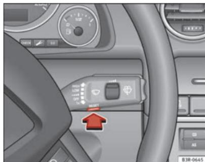
Fig. 62 Palanca del limpiaparabrisas: Tecla de manejo para seleccionar menús
