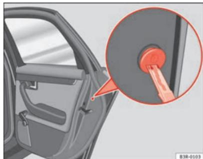
Fig. 73 Dispositivo de bloqueo de emergencia
