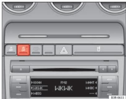
Fig. 137 Detalle del pulsador del funcionamiento Start-Stop.
