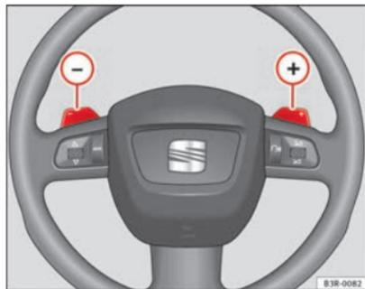
Fig. 152 Volante: Mandos del tiptronic
