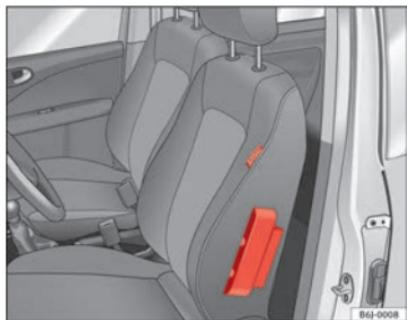
**Fig. 24 Airbag lateral en el asiento del conductor**
