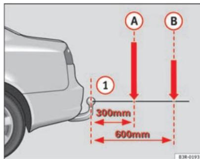
Fig. 154 Representación básica de la distribución de la carga de piezas accesorias y accesorios
