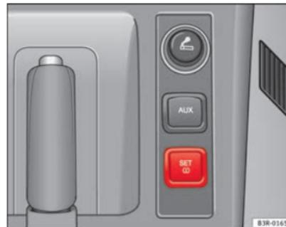
Fig. 177 Detalle de la consola central: Tecla del indicador de la presión de los neumáticos
