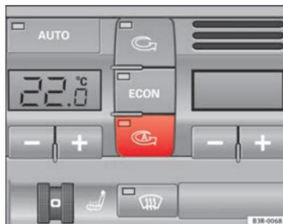
**Fig. 130** Tecla para la recirculación de aire automática
