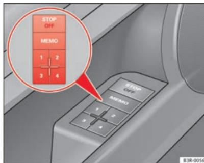
Fig. 109 Puerta del conductor: Sistema de memoria
