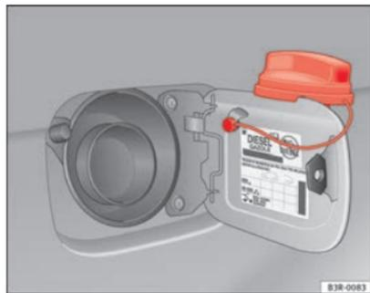
Fig. 167 Tapa del depósito con el tapón encajado
