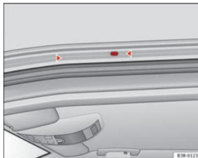
**Fig. 118 Puntos de fijación para soportes básicos**
