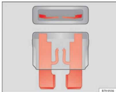
Fig. 190 Representación de un fusible fundido.
