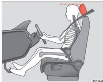
**Fig. 2** Posición correcta del apoyacabezas del conductor
