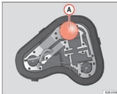
Fig. 214 Ubicación de la lámpara de incandescencia en el portalámparas. Ejemplo: Piloto posterior izquierdo en la aleta.
