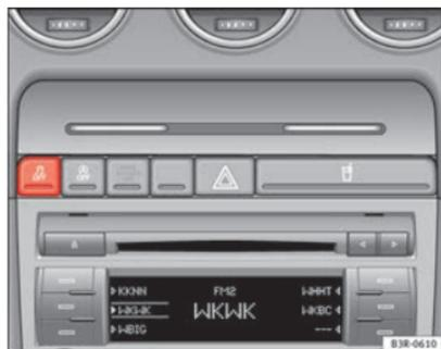
**Fig. 153** Consola central con el interruptor del ESC
