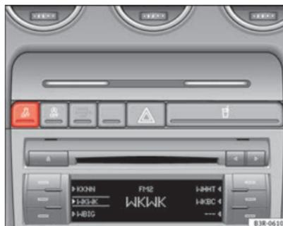
Fig. 134 Detalle de la consola central: tecla ESC ▶
