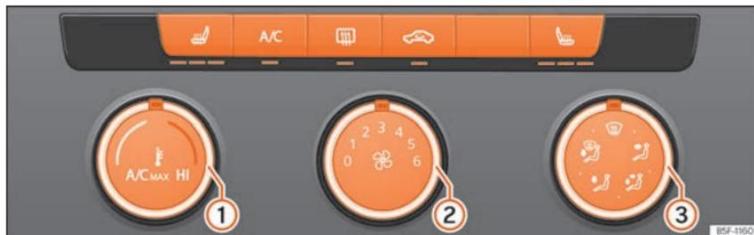
**Fig. 146** En la consola central: Mandos del aire acondicionado manual.
