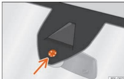
**Fig. 147** Sensor de humedad y temperatura del parabrisas.
