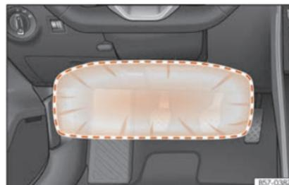
**Fig. 19** En el lado del conductor: radio de acción del airbag para las rodillas.
