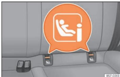
**Fig. 26** Asiento trasero: anillas de sujeción ISOFIX/i-Size.
