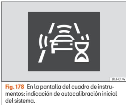
**Fig. 178** En la pantalla del cuadro de instrumentos: indicación de autocalibración inicial del sistema.
