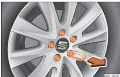
**Fig. 34** Rueda: tornillos de la rueda con capuchones.
