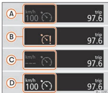
**Fig. 172** Pantalla del cuadro de instrumentos: indicaciones de estado del GRA.
