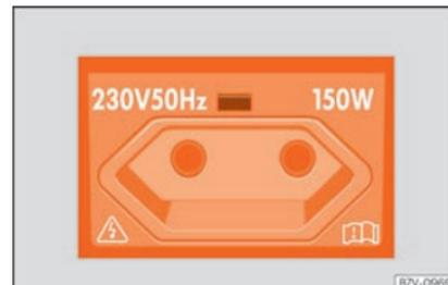
**Fig. 144** En el lado izquierdo del maletero: toma de corriente de 230 voltios.
