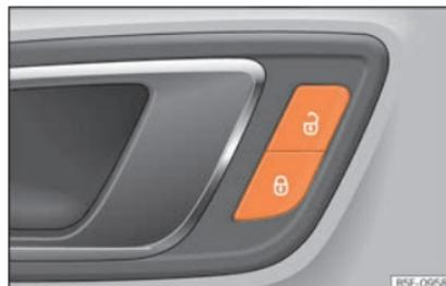
**Fig. 90** Puerta del conductor: conmutador del cierre centralizado.
