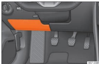
**Fig. 49** Vehículos con volante a la izquierda: tapa de la caja de fusibles debajo del tablero de instrumentos del lado del conductor
