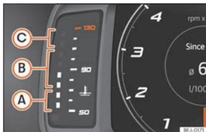
**Fig. 74** Cuadro de instrumentos digital: indicador de temperatura del líquido refrigerante del motor.
