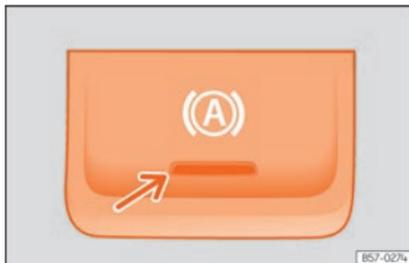
**Fig. 194** En la parte inferior de la consola central: tecla de la función Auto Hold.
