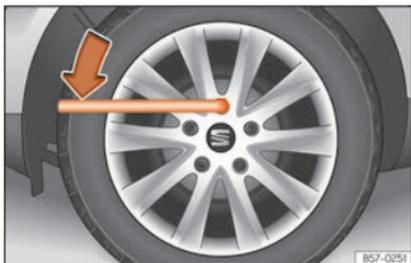
**Fig. 36** Cambio de rueda: aflojar los tornillos de rueda.
