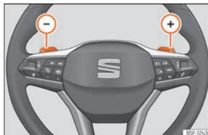
**Fig. 163** Volante: palancas para cambio automático.
