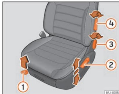
Fig. 117 Asientos delanteros: ajuste manual del asiento.
