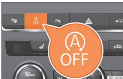
**Fig. 159** Consola central: tecla del sistema Start-Stop.
