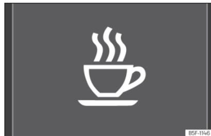
**Fig. 69** En la pantalla del cuadro de instrumentos: símbolo de detección de cansancio.
