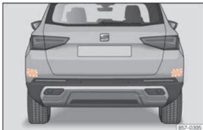
**Fig. 169** Vista trasera del vehículo: zonas de los sensores de radar.
