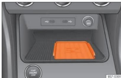
**Fig. 154** En la consola central: alojamiento para la conexión del teléfono móvil.
