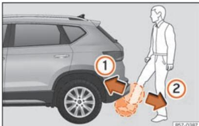
**Fig. 100** Portón del maletero con apertura controlada por sensor (Easy Open).
