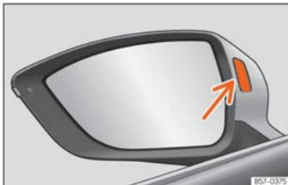
**Fig. 188** Testigo de control del asistente de cambio de carril.
