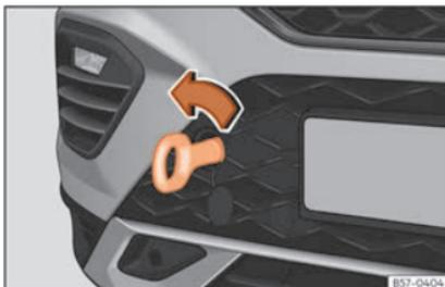
**Fig. 46** En el lado derecho del paragolpes delantero: argolla de remolque enroscada.
