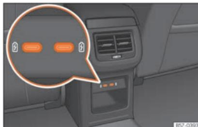
**Fig. 156** Parte posterior consola central: conectores USB con función de toma de corriente.
