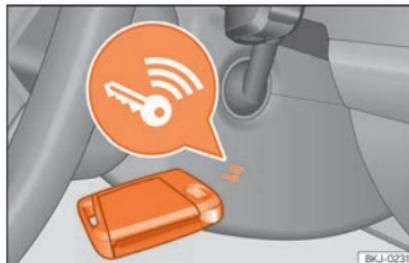
**Fig. 158** A la derecha de la columna de dirección: arranque de emergencia.
