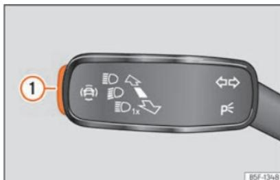
**Fig. 77** En la palanca de intermitentes y de luz de carretera: tecla para los sistemas de asistencia al conductor (según versiones).
