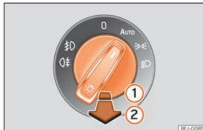
Fig. 108 Tablero de instrumentos: mando de las luces.
