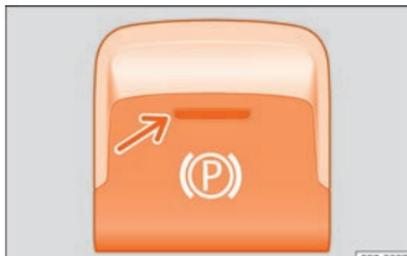
**Fig. 193** En la parte inferior de la consola central: tecla del freno de estacionamiento electrónico.
