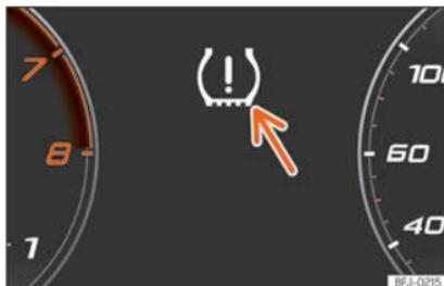
**Fig. 230** Cuadro de instrumentos: aviso de pérdida de presión de los neumáticos.
