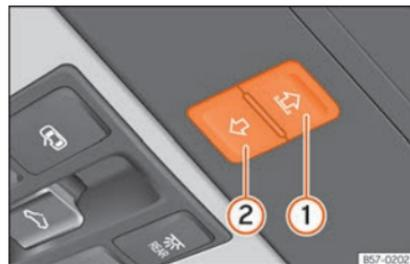
**Fig. 105** En el revestimiento interior del techo: teclas de la cortinilla parasol.
