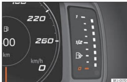
**Fig. 72** Cuadro de instrumentos digital: indicador del nivel de combustible.
