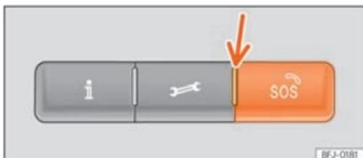
**Fig. 30** En la consola del techo: mandos para los servicios de voz
