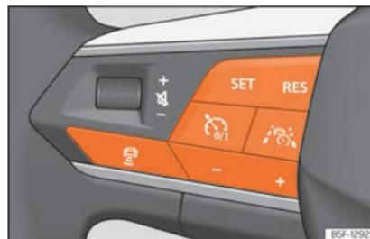
**Fig. 187** Lado izquierdo del volante multifunción: teclas para el manejo del Travel Assist.
