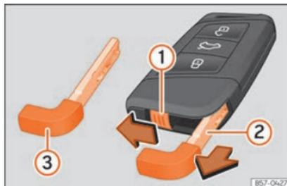
**Fig. 86** Llave del vehículo: extraer la llave de emergencia.
