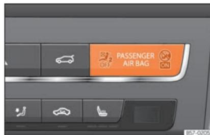
**Fig. 17** Tablero de instrumentos: testigo de control de la desactivación del airbag del acompañante.
