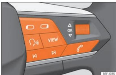
**Fig. 75** Lado derecho del volante multifunción: teclas para utilizar los menús y las indicaciones informativas del cuadro de instrumentos.
