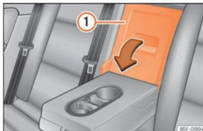
**Fig. 136** En el respaldo del asiento trasero: apertura de la trampilla.
