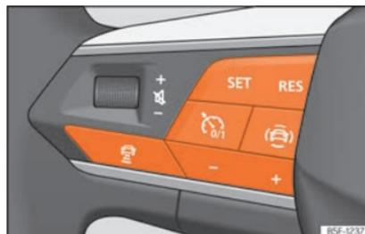
Fig. 179 En el volante multifunción: botones para manejar el ACC
