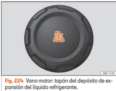
**Fig. 224** Vano motor: tapón del depósito de expansión del líquido refrigerante.
