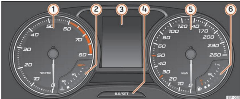
**Fig. 67** Cuadro de instrumentos en el tablero de instrumentos.
