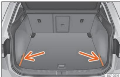
**Fig. 128** En el maletero: tapas para guardar la bandeja.
