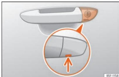
Fig. 93 Manecilla de la puerta del conductor: bombín de cierre oculto.
