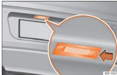
**Fig. 63** En el parachoques trasero: luz de matrícula.
