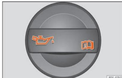
Fig. 222 Tapón de la boca de llenado de aceite del motor en el vano motor.
