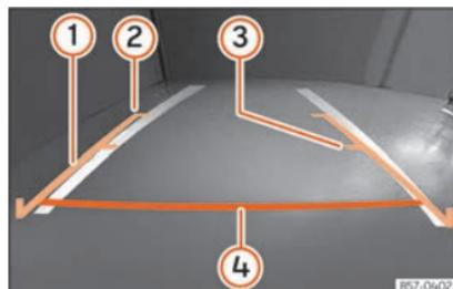
**Fig. 211** Visualización en la pantalla del sistema de infotainment: líneas de orientación.
