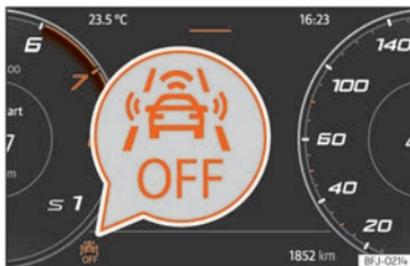
Fig. 177 En la pantalla del cuadro de instrumentos: indicación de Front Assist desactivado.
