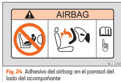
Fig. 24 Adhesivo del airbag: en el parasol del lado del acompañante
