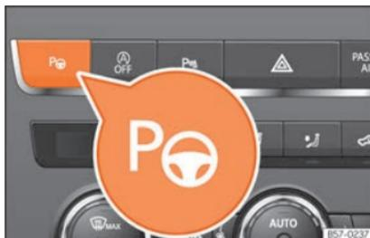
**Fig. 195** En la parte superior de la consola central: tecla para conectar el sistema de aparcamiento asistido.
