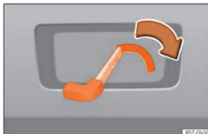
**Fig. 102** Detalle del maletero: desbloqueo de emergencia.
