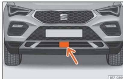
**Fig. 166** En el paragolpes delantero: sensor de radar.
