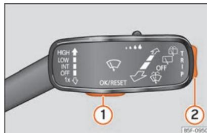
**Fig. 76** Palanca del limpiaparabrisas: teclas de control.
