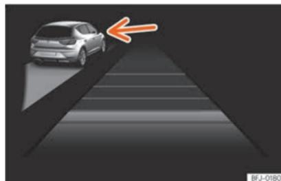
**Fig. 181** En la pantalla del cuadro de instrumentos: ACC activo, vehículo detectado por la izquierda
