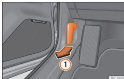
**Fig. 218** Palanca de desbloqueo en el espacio reposapiés del conductor.
