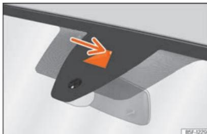
**Fig. 168** En el parabrisas: área de campo visual del sistema de aviso de salida del carril.
