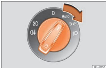
Fig. 107 Tablero de instrumentos: mando de las luces.
