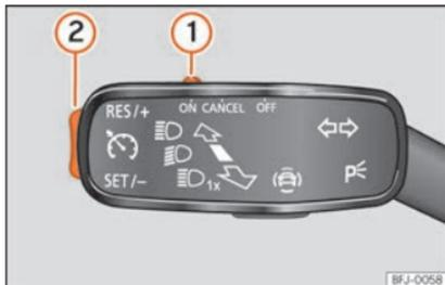
**Fig. 173** En la palanca de los intermitentes: mandos para el manejo del GRA.
