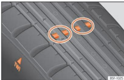
**Fig. 228** Perfil del neumático: indicadores de desgaste.
