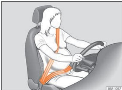
**Fig. 13** Colocación de la banda del cinturón en el caso de mujeres embarazadas.
