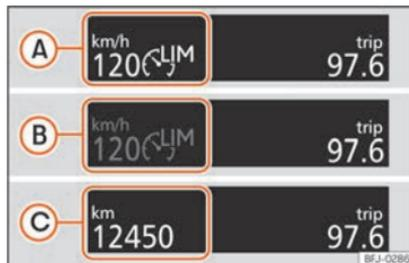
**Fig. 174** En la pantalla del cuadro de instrumentos: indicaciones del estado del limitador de velocidad.
