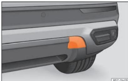
**Fig. 47** En el lado derecho del paragolpes trasero: retirar la tapa.
