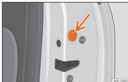
**Fig. 95** Bloqueo de emergencia de la puerta.
