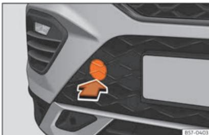
**Fig. 45** En el lado derecho del paragolpes delantero: retirar la tapa.
