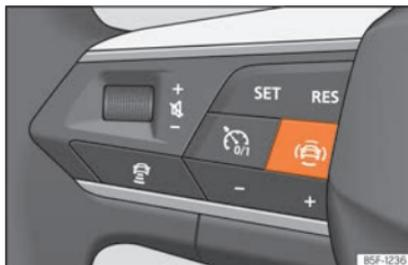
**Fig. 78** Lado izquierdo del volante multifunción: tecla para los sistemas de asistencia al conductor (según versiones).
