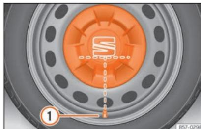
**Fig. 33** Colocación correcta del embellecedor central de rueda para llantas de acero.
