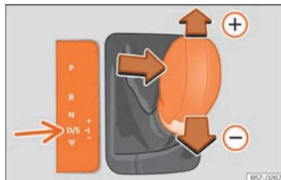
**Fig. 162** Palanca selectora en la posición Tiptronic
