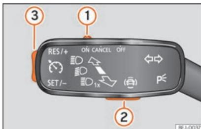
**Fig. 175** En la palanca de los intermitentes: teclas para manejar el limitador de velocidad.
