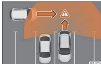
**Fig. 192** Representación esquemática del asistente de desaparcamiento: zona vigilada alrededor del vehículo que está desaparcando.
