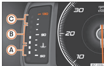
Fig. 131 Cuadro de instrumentos digital: indicador de temperatura del líquido refrigerante del motor.
