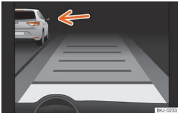
Fig. 263 En la pantalla del cuadro de instrumentos: ACC activo, vehículo detectado por la izquierda
