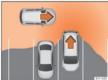
Fig. 275 Representación esquemática del asistente de desaparcamiento: zona vigilada alrededor del vehículo que está desaparcando.
