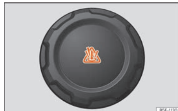
Fig. 64 Vano motor: tapón del depósito de expansión del líquido refrigerante.
