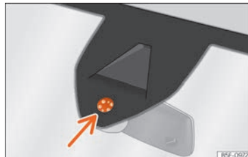
Fig. 186 Sensor de humedad y temperatura del parabrisas.
