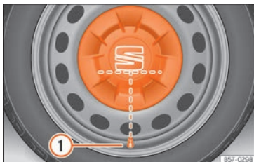
Fig. 74 Colocación correcta del embellecedor central de rueda para llantas de acero.
