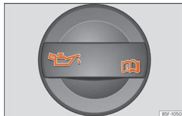
Fig. 63 Tapón de la boca de llenado de aceite del motor en el vano motor. »»
