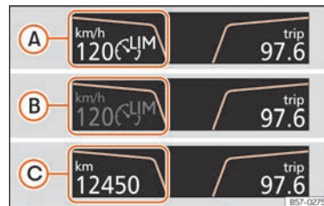
Fig. 251 En la pantalla del cuadro de instrumentos: indicaciones del estado del limitador de velocidad.
