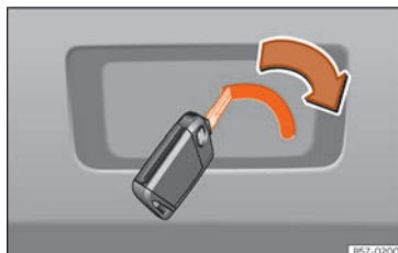
Fig. 11 Detalle del maletero: desbloqueo de emergencia.
