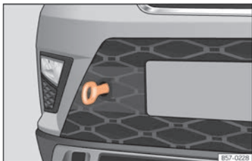
Fig. 80 Parte derecha del parachoques delantero: argolla de remolque enroscada.
