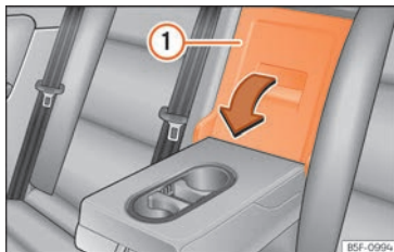
Fig. 174 En el respaldo del asiento trasero: apertura de la trampilla.
