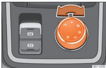
Fig. 278 Consola central: Mando rotativo [Driving Experience button] en el modelo Cupra.
