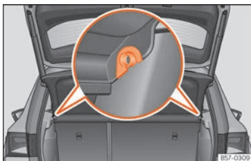
Fig. 171 En el maletero: desmontar y montar la bandeja.
