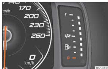
Fig. 129 Cuadro de instrumentos digital: indicador del nivel de combustible.
