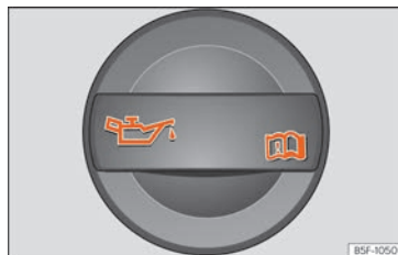
Fig. 306 Tapón de la boca de llenado de aceite del motor en el vano motor.
