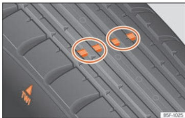
Fig. 308 Perfil del neumático: indicadores de desgaste.
