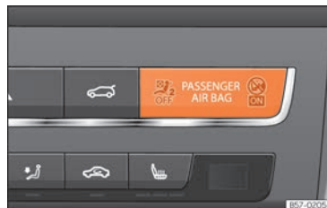
Fig. 29 Tablero de instrumentos: testigo de control de la desactivación del airbag del acompañante.
