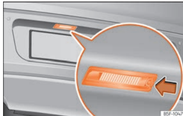
Fig. 118 En el parachoques posterior: luz de matrícula.
