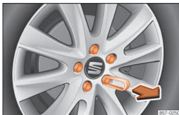
Fig. 75 Rueda: tornillos de la rueda con capuchones.
