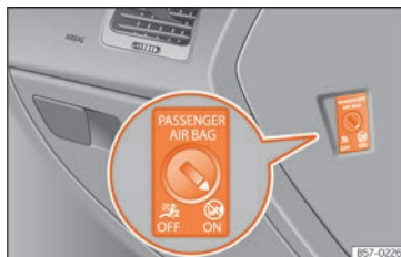
Fig. 28 Conmutador del airbag frontal del acompañante.
