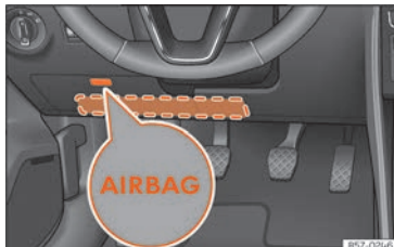
Fig. 30 En el lado del conductor: ubicación del airbag para las rodillas.
