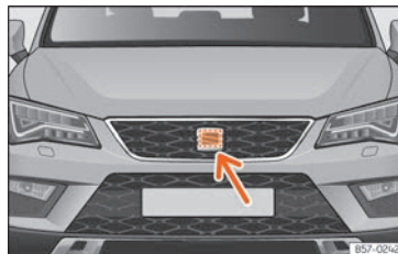
Fig. 255 En el frontal tras el emblema de SEAT: sensor de radar.
