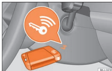
Fig. 242 A la derecha de la columna de dirección: arranque de emergencia.
