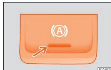
Fig. 249 En la parte inferior de la consola central: tecla de la función Auto Hold.
