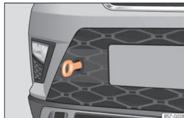
Fig. 102 En el lado derecho del paragolpes delantero: argolla de remolque enroscada.
