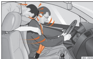
Fig. 95 El ocupante del asiento trasero que no lleve puesto el cinturón de seguridad se verá lanzado hacia delante sobre el conductor que sí lleva el cinturón.
