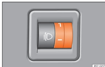
Fig. 154 Al lado del volante: regulador del alcance de las luces.
