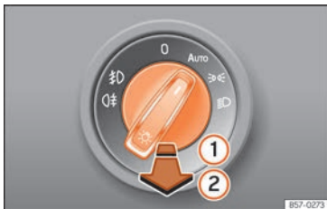
Fig. 152 Tablero de instrumentos: mando de las luces.
