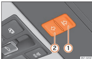
Fig. 149 En el revestimiento interior del techo: teclas de la cortinilla parasol.
