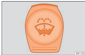
Fig. 66 En el vano motor: tapón del depósito del limpiacristales.
