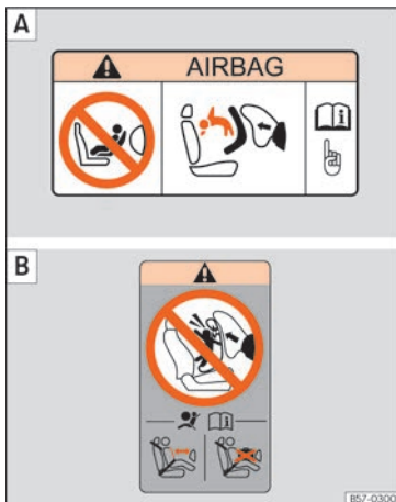
Fig. 37 Adhesivos del airbag - versión 2: en el parasol del lado del acompañante A y en el marco posterior de la puerta del acompañante B .
