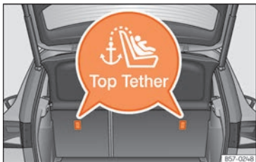
Fig. 40 Posición de las anillas Top Tether en la parte posterior del asiento trasero.
