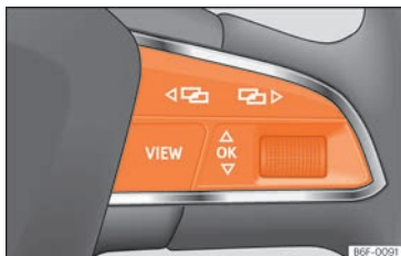
Fig. 133 Lado derecho del volante multifunción: teclas para utilizar los menús y las indicaciones informativas del cuadro de instrumentos.
