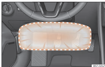
Fig. 31 En el lado del conductor: radio de acción del airbag para las rodillas.
