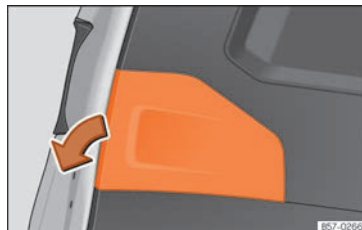
Fig. 116 Portón trasero abierto: retirar la tapa.
