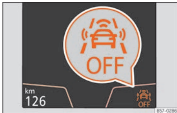
Fig. 256 En la pantalla del cuadro de instrumentos: indicación de Front Assist desactivado.
