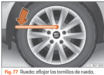
Fig. 77 Rueda: aflojar los tornillos de rueda.
