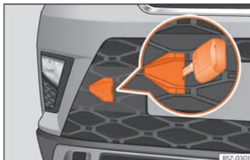
Fig. 101 En el lado derecho del paragolpes delantero: retirar la tapa.
