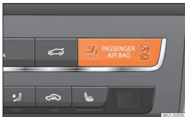
Fig. 99 Tablero de instrumentos: testigo de control de la desactivación del airbag del acompañante.
