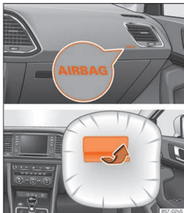
Fig. 27 Airbag del acompañante en el tablero de instrumentos.
