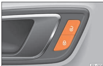
Fig. 5 Puerta del conductor: conmutador del cierre centralizado.
