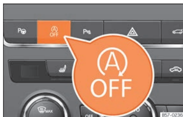
Fig. 248 Consola central: tecla del sistema Start-Stop.
