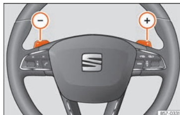
Fig. 246 Volante: palancas para cambio automático.
