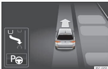
Fig. 282 En la pantalla del cuadro de instrumentos: visualización del sistema de aparcamiento asistido con visualización reducida.
