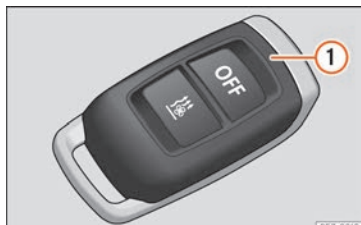
Fig. 187 Calefacción independiente: mando a distancia por radiofrecuencia.
