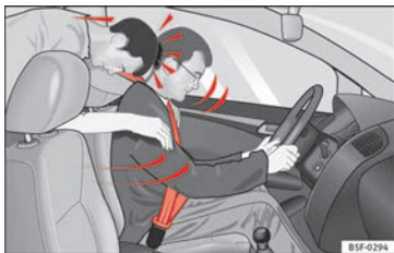
Fig. 92 El ocupante del asiento trasero que no lleve puesto el cinturón de seguridad se verá lanzado hacia delante sobre el conductor que sí lleva el cinturón.
