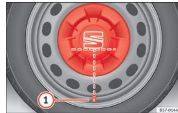
Fig. 71 Colocación correcta del embellecedor central de rueda para llantas de acero.
