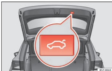
Fig. 137 Portón trasero abierto: tecla para cerrar el portón inmediatamente.
