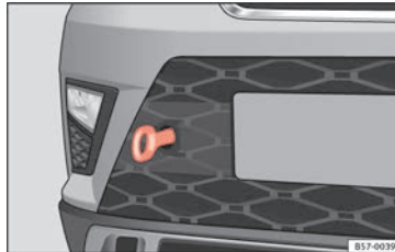
Fig. 77 Parte derecha del parachoques delantero: argolla de remolque enroscada.
