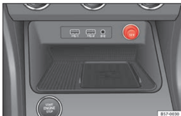
Fig. 157 Consola central: toma de corriente de 12 voltios.
