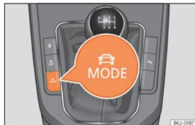
**Fig. 92** Junto a la palanca de cambios: tecla MODE.
