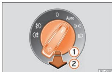
**Fig. 71** Tablero de instrumentos: mando de las luces.
