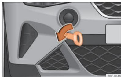
**Fig. 165** Parte derecha del paragolpes delantero: argolla de remolque enroscada.
