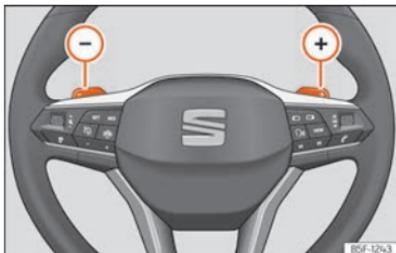
**Fig. 90** Volante: palancas para cambio automático.
