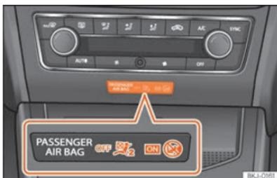
**Fig. 31** Parte central del tablero de instrumentos: testigo de control de la desactivación del airbag del acompañante.
