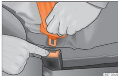
**Fig. 25** Soltar la lengüeta del cierre del cinturón.
