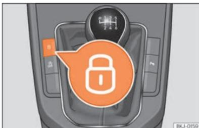
**Fig. 53** Consola central: botón del cierre centralizado.
