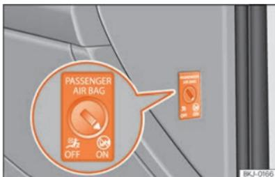
**Fig. 30** Conmutador con llave para activar y desactivar el airbag del acompañante.
