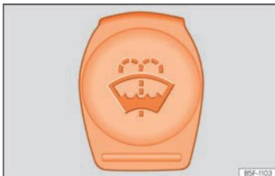
**Fig. 183** En el vano motor: tapón de color azul del depósito del limpiacristales.
