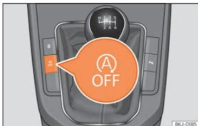
**Fig. 86** Consola central: tecla del sistema Start-Stop.
