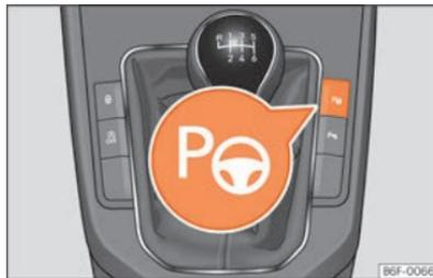
**Fig. 123** En la consola central: tecla para conectar el sistema de aparcamiento asistido.
