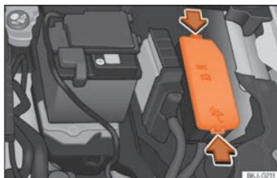
**Fig. 169** En el vano motor: tapa de la caja de fusibles.
