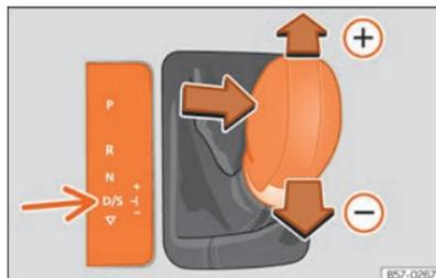
**Fig. 89** Palanca selectora en la posición Tiptronic
