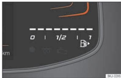
**Fig. 5** Cuadro de instrumentos Basic: indicador del nivel de combustible.
