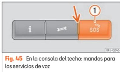
Fig. 45 En la consola del techo: mandos para los servicios de voz
