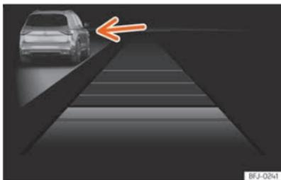
**Fig. 105** En la pantalla del cuadro de instrumentos: ACC activo, vehículo detectado por la izquierda.
