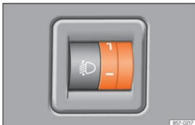
**Fig. 73** Al lado del volante: regulador del alcance de las luces.
