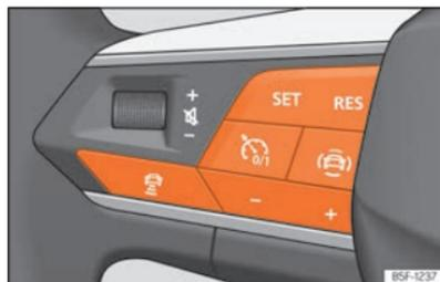
**Fig. 104** En el volante multifunción: botones para manejar el ACC.
