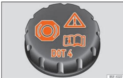
**Fig. 182** Vano motor: tapón del depósito del líquido de frenos.
