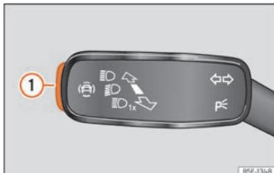
**Fig. 93** En la palanca de intermitentes y de luz de carretera: tecla para los sistemas de asistencia al conductor (según versiones).
