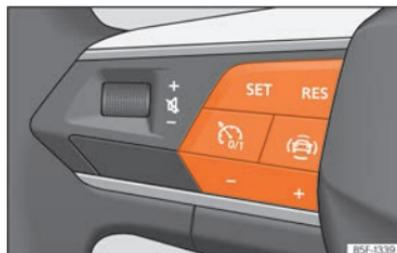
**Fig. 102** En el volante multifunción: botones para manejar el limitador de velocidad.
