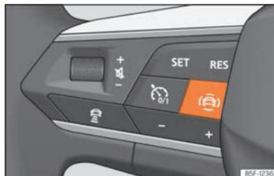
**Fig. 94** Lado izquierdo del volante multifunción: tecla para los sistemas de asistencia al conductor (según versiones).
