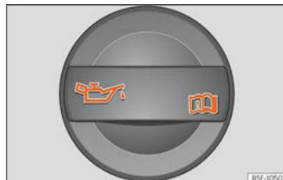
**Fig. 187** Tapa de la boca de llenado de aceite del motor en el vano motor.
