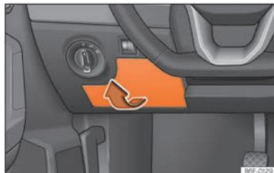
**Fig. 168** En el tablero de instrumentos del lado del conductor: tapa de la caja de fusibles.
