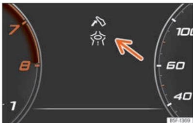
**Fig. 12** Indicación de la asistencia para una conducción ecoeficiente (representación esquemática).
