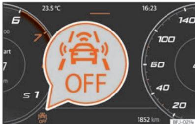
**Fig. 110** En la pantalla del cuadro de instrumentos: indicación de Front Assist desactivado.
