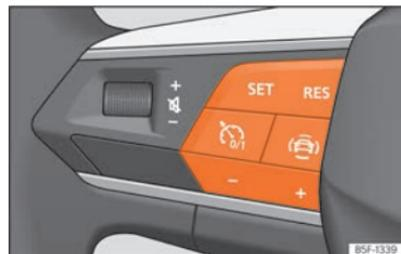
Fig. 101 En el volante multifunción: botones para manejar el regulador de velocidad.
