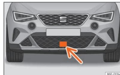
**Fig. 95** En el paragolpes delantero: sensor de radar.
