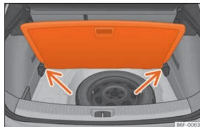
**Fig. 146** Suelo variable del maletero: posición inclinada.
