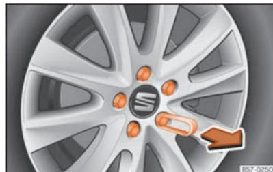
**Fig. 194** Rueda: tornillos de la rueda con capuchones.
