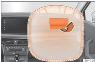
**Fig. 29** Airbag del acompañante en el tablero de instrumentos.
