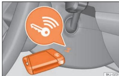
**Fig. 85** A la derecha de la columna de dirección: arranque de emergencia.
