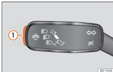
Fig. 92 En la palanca de intermitentes y de luz de carretera: tecla para los sistemas de asistencia al conductor (según versiones).
