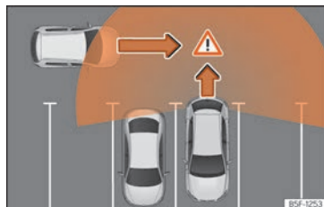
Fig. 129 Representación esquemática del asistente de desaparcamiento: zona vigilada alrededor del vehículo que está desaparcando.
