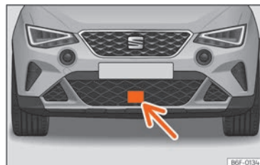
Fig. 94 En el paragolpes delantero: sensor de radar.
