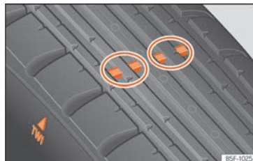
Fig. 189 Perfil del neumático: indicadores de desgaste.
