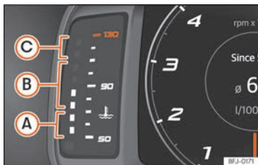
Fig. 9 Cuadro de instrumentos digital SEAT Digital Cockpit: indicador de temperatura del líquido refrigerante del motor.
