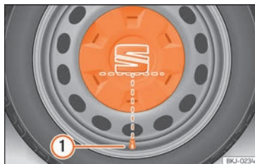
Fig. 192 Colocación correcta del embellecedor central de rueda para llantas de acero.
