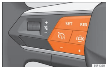
Fig. 100 En el volante multifunción: botones para manejar el regulador de velocidad.
