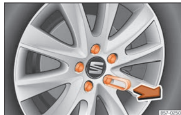
Fig. 193 Rueda: tornillos de la rueda con capuchones.
