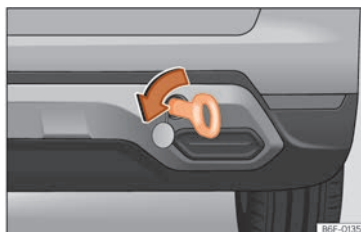
Fig. 166 En el lado derecho del paragolpes trasero: argolla de remolque enroscada.
