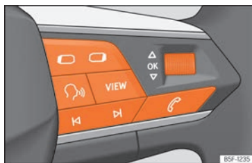
Fig. 13 Lado derecho del volante multifunción: teclas para utilizar los menús y las indicaciones informativas del cuadro de instrumentos (según versiones).
