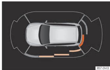
Fig. 120 Visualización de ayuda al aparcamiento en la pantalla del sistema de infotainment.
