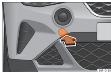
Fig. 163 En el lado derecho del paragolpes delantero: retirar la tapa.
