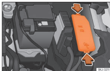
Fig. 168 En el vano motor: tapa de la caja de fusibles.
