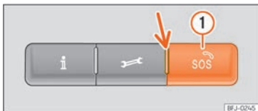
Fig. 45 En la consola del techo: mandos para los servicios de voz
