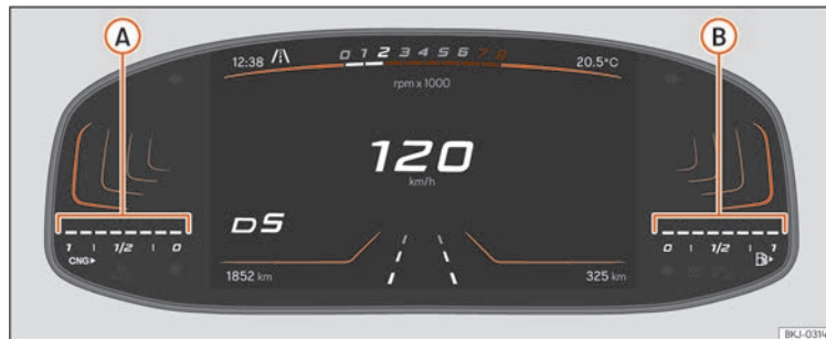
Fig.7 Cuadro de instrumentos: indicador de nivel de gas natural
