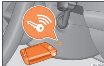
Fig. 84 A la derecha de la columna de dirección: arranque de emergencia.
