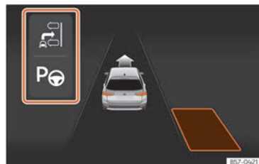
Fig. 123 En la pantalla del cuadro de instrumentos: visualización del sistema de aparcamiento asistido con visualización reducida.
