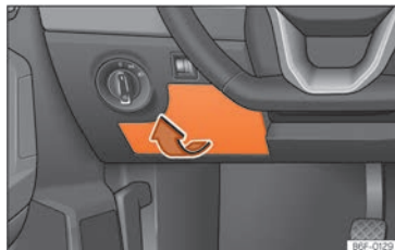
Fig. 167 En el tablero de instrumentos del lado del conductor: tapa de la caja de fusibles.
