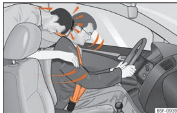
Fig. 23 El ocupante del asiento trasero que no lleve puesto el cinturón de seguridad se verá proyectado hacia delante sobre el conductor que sí lleva el cinturón.
