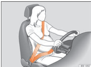
Fig. 27 Colocación de la banda del cinturón en el caso de mujeres embarazadas.
