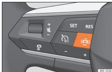
Fig. 93 Lado izquierdo del volante multifunción: tecla para los sistemas de asistencia al conductor (según versiones).
