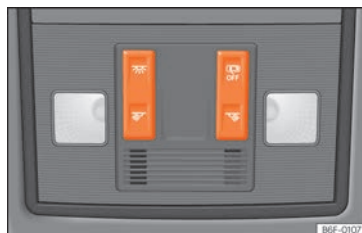
Fig. 74 Detalle del revestimiento del techo: iluminación delantera del habitáculo.
