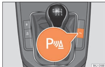
Fig. 119 Consola central: tecla de la ayuda de aparcamiento [según versiones].
