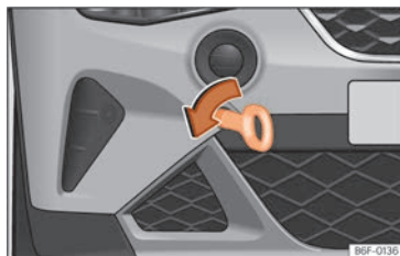
Fig. 164 Parte derecha del paragolpes delantero: argolla de remolque enroscada.
