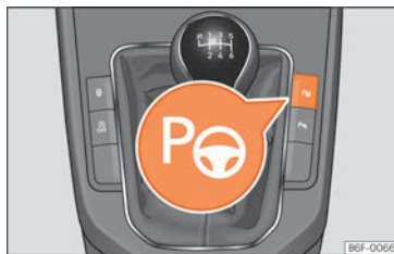
Fig. 122 En la consola central: tecla para conectar el sistema de aparcamiento asistido.
