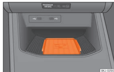
Fig. 141 En la consola central: alojamiento para la conexión del teléfono móvil.
