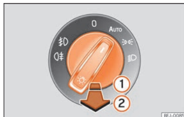
Fig. 71 Tablero de instrumentos: mando de las luces.
