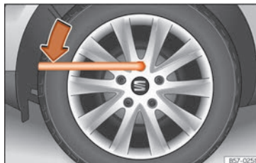
Fig. 195 Cambio de rueda: aflojar los tornillos de rueda.
