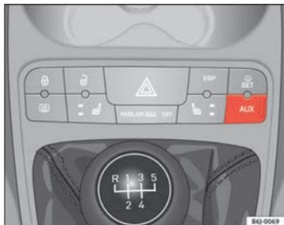
Fig. 9 Conexión AUX-IN en modelos Ibiza.
