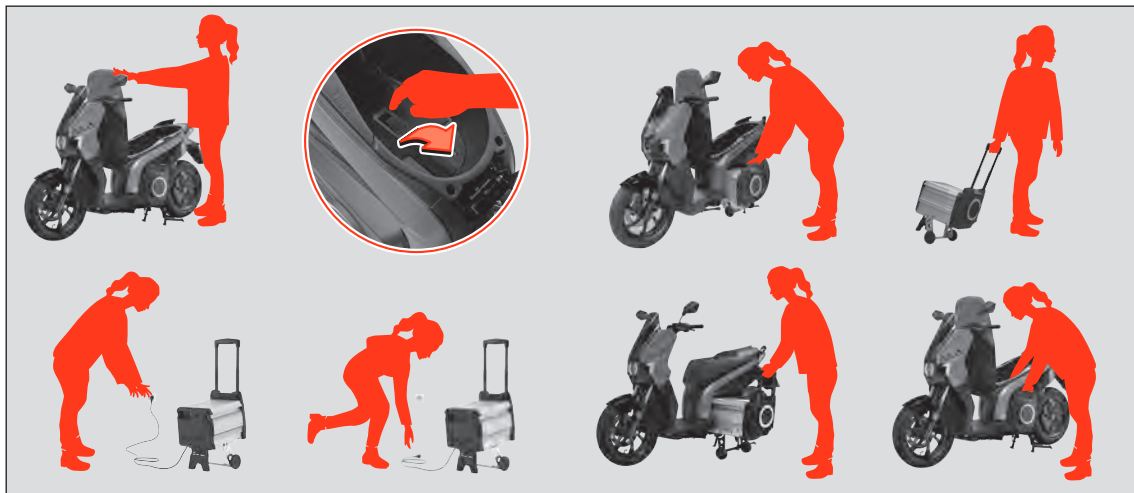
Fig. 31 Extracción de la batería
