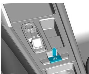
2. Accionar freno de bloqueo eléctrico de estacionamiento.
