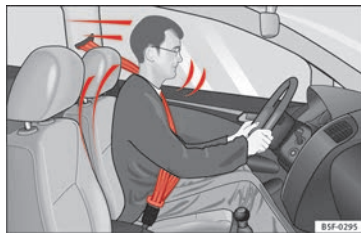
Fig. 90 Los conductores que lleven el cinturón de seguridad correctamente abrochado no saldrán lanzados en caso de un frenazo brusco.
