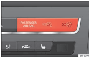
Fig. 53 Testigo para desconexión de airbag del acompañante.
