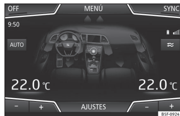
Fig. 189 Pantalla del Easy Connect: menú Climatizador.
