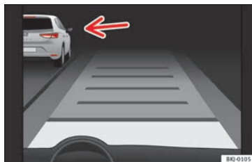
Fig. 213 En la pantalla del cuadro de instrumentos: ACC activo, vehículo detectado por la izquierda
