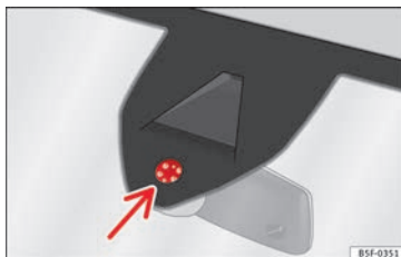
Fig. 148 Superficie sensible del sensor de lluvia.
