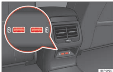
Fig. 129 Parte posterior consola central: conectores USB.
