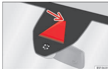
Fig. 216 En el parabrisas: área de campo visual del sistema de aviso de salida del carril.
