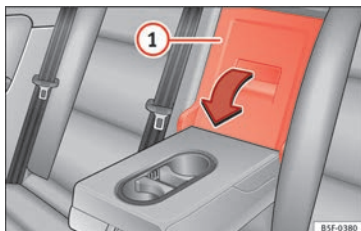
Fig. 175 En el respaldo del asiento trasero: apertura de la trampilla.
