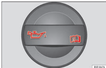
Fig. 249 Tapón de la boca de llenado de aceite del motor en el vano motor.
