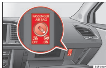
Fig. 95 Conmutador con llave para activar y desactivar el airbag del acompañante.
