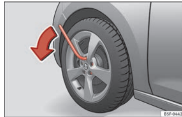
Fig. 74 Rueda: aflojar los tornillos de rueda.
