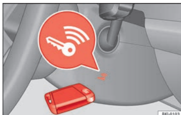
Fig. 193 A la derecha de la columna de dirección: arranque de emergencia.
