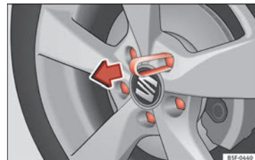
Fig. 72 Rueda: tornillos de la rueda con capuchones.
