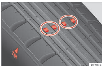
Fig. 251 Perfil del neumático: indicadores de desgaste.
