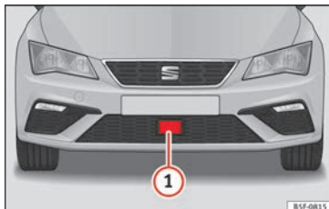
Fig. 210 En el paragolpes delantero: sensor de radar.
