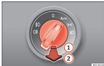
Fig. 142 Tablero de instrumentos: mando de las luces.
