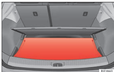
Fig. 168 En el maletero: colocación de la bandeja portaobjetos.
