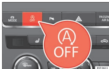
Fig. 201 Consola central: tecla del sistema Start-Stop.
