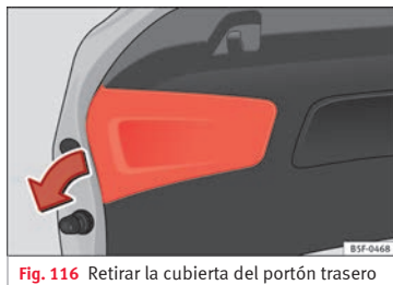
Fig. 116 Retirar la cubierta del portón trasero
