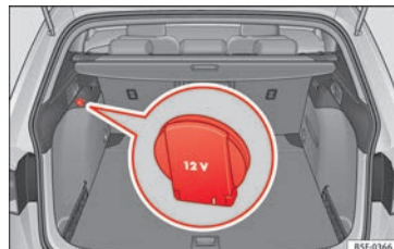
Fig. 162 Detalle del revestimiento lateral del maletero: toma de corriente de 12 voltios (válido sólo para el modelo LEON ST).
