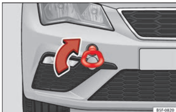
Fig. 98 Parte derecha del parachoques delantero: argolla de remolque enroscada.
