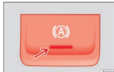
Fig. 202 En la parte inferior de la consola central: tecla de la función Auto Hold.
