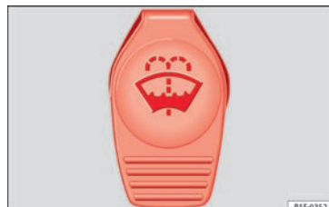
Fig. 65 En el vano motor: tapón del depósito del limpiacristales.
