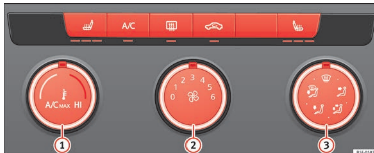
Fig. 58 En la consola central: mandos del aire acondicionado manual.
