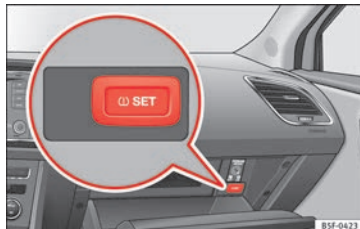
Fig. 254 Guantera: interruptor para el control de los neumáticos.
