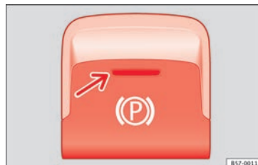
Fig. 195 En la parte inferior de la consola central: tecla del freno de estacionamiento electrónico.
