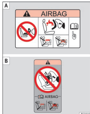
Fig. 29 Adhesivos del airbag - versión 1: en el parasol del lado del acompañante A y en el marco posterior de la puerta del acompañante B .
