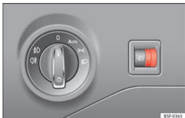
Fig. 144 Al lado del volante: regulador del alcance de las luces.
