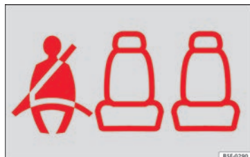
Fig. 89 Cuadro de instrumentos: indicación de plaza posterior derecha ocupada y abrochado el cinturón correspondiente.
