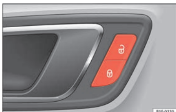
Fig. 2 Puerta del conductor: conmutador del cierre centralizado.
