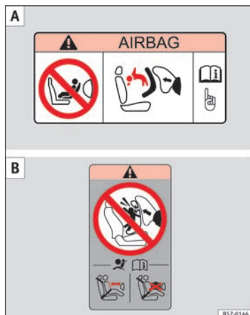
Fig. 30 Adhesivos del airbag - versión 2: en el parasol del lado del acompañante A y en el marco posterior de la puerta del acompañante B .
