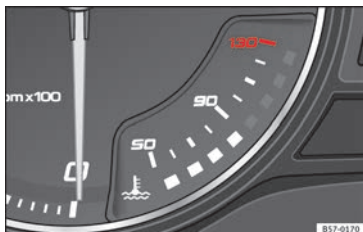
Fig. 124 Cuadro de instrumentos: indicador de la temperatura del líquido refrigerante
