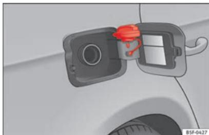
Fig. 58 Tapa del depósito con el tapón encajado.
