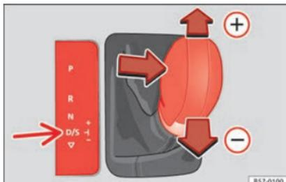
**Fig. 195** Consola central: cambiar con tiptronic.
