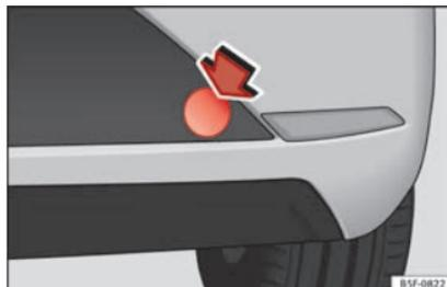
**Fig. 98** Parte derecha del parachoques trasero: tapa-cubierta.
