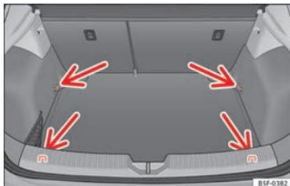
Fig. 174 En el maletero: argollas de amarre (modelo LEÓN/LEÓN SC excepto versiones con rueda de recambio de dotación y GNC).
