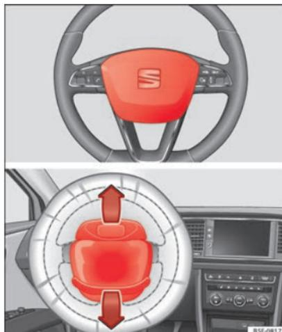
**Fig. 20** Airbag del conductor en el volante.
