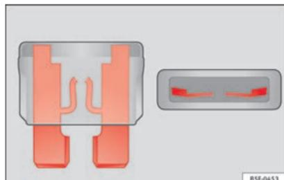
**Fig. 66** Representación de un fusible fundido.
