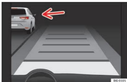
**Fig. 208** En la pantalla del cuadro de instrumentos: ACC activo, vehículo detectado por la izquierda
