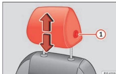
Fig. 15 Asiento delantero: regulación del apoyacabezas.
