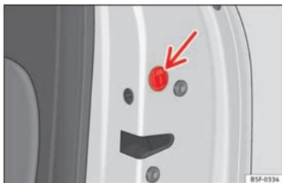
**Fig. 4** Bloqueo de emergencia de la puerta.
