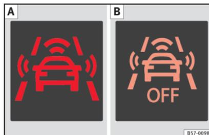
**Fig. 215** En la pantalla del cuadro de instrumentos: **A** Indicación del preaviso. **B** Detección de peatones desactivada.
