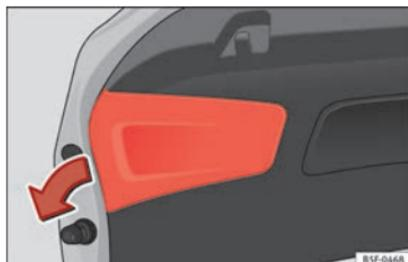
**Fig. 115** Retirar la cubierta del portón del maletero
