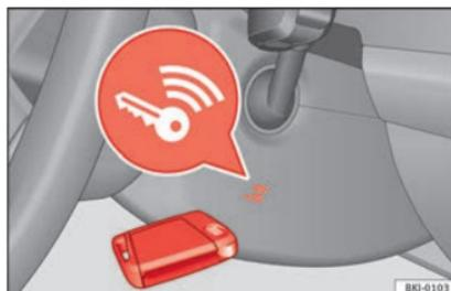
**Fig. 189** A la derecha de la columna de dirección: arranque de emergencia.
