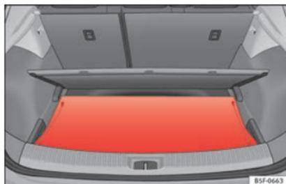
Fig. 165 En el maletero: colocación de la bandeja portaobjetos.
