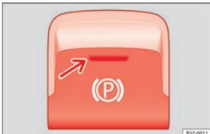
**Fig. 191** En la parte inferior de la consola central: tecla del freno de estacionamiento electrónico.
