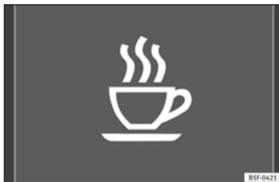
**Fig. 223** En la pantalla del cuadro de instrumentos: símbolo de detección de cansancio.
