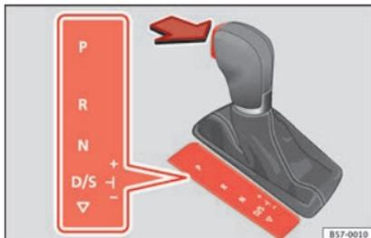
Fig. 194 Bloqueo de la palanca selector.
