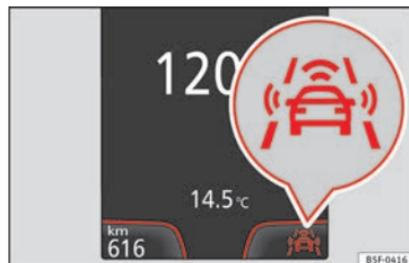
Fig. 213 En la pantalla del cuadro de instrumentos: indicación de Front Assist desactivado.
