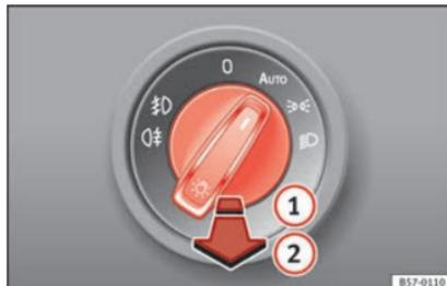
**Fig. 139** Tablero de instrumentos: mando de las luces.
