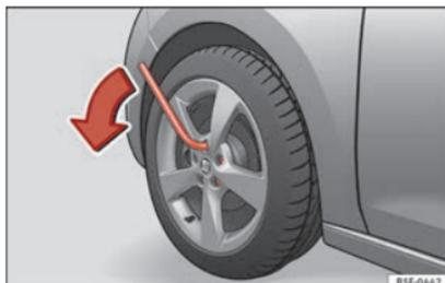
**Fig. 72** Rueda: aflojar los tornillos de rueda.
