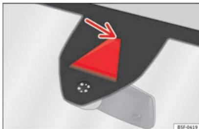
**Fig. 218** En el parabrisas: área de campo visual del sistema de aviso de salida del carril.
