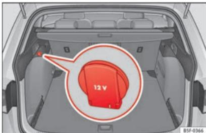
**Fig. 159** Detalle del revestimiento lateral del maletero: toma de corriente de 12 voltios (válido sólo para el modelo LEON ST).
