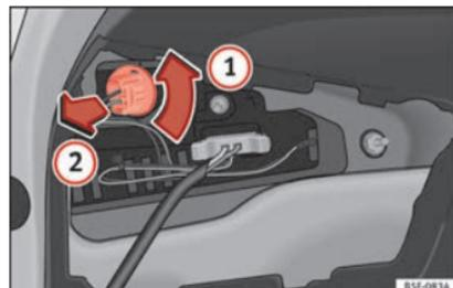
**Fig. 116** Desmontar el portalámparas.
