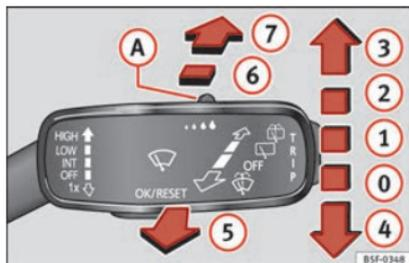
**Fig. 39** Manejo del limpiaparabrisas y limpialuneta.
