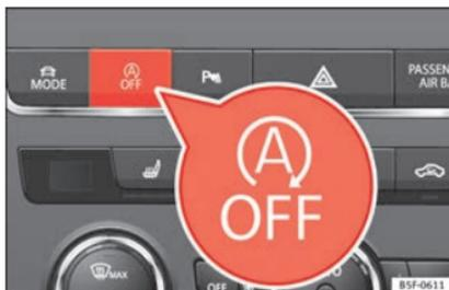
**Fig. 197** Consola central: tecla del sistema Start-Stop.
