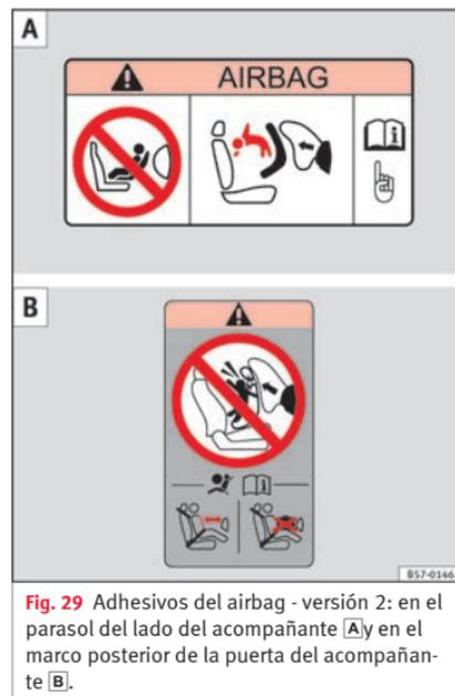
**Fig. 29** Adhesivos del airbag - versión 2: en el parasol del lado del acompañante **A** y en el marco posterior de la puerta del acompañante **B**.
