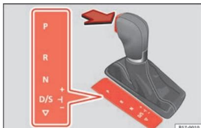
**Fig. 53** Cambio automático: posiciones de la palanca selectora.
