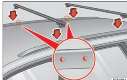
**Fig. 185** Leon ST: puntos de fijación de las barras longitudinales para el portaequipajes del techo.
