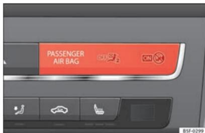
**Fig. 95** Testigo para desconexión de airbag del acompañante.
