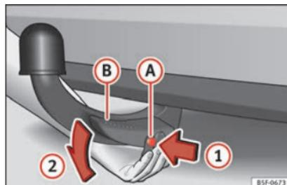
Fig. 242 Soltar la bola desmontable
