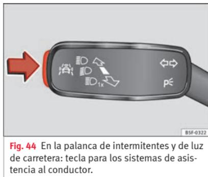
**Fig. 44** En la palanca de intermitentes y de luz de carretera: tecla para los sistemas de asistencia al conductor.
