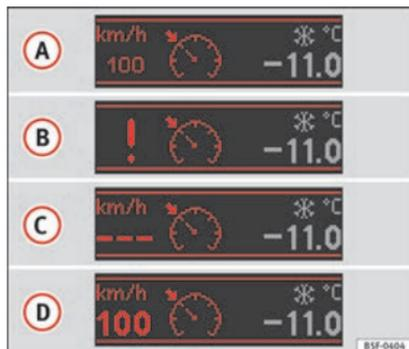
Fig. 199 Pantalla del cuadro de instrumentos: indicaciones de estado del GRA.
