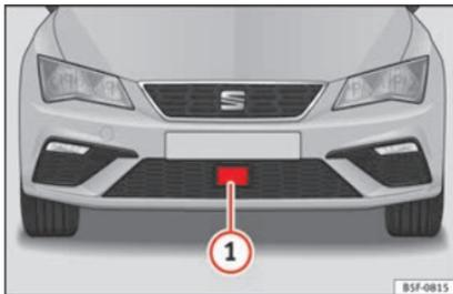
**Fig. 203** En el paragolpes delantero: sensor de radar.
