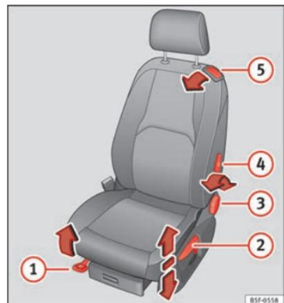
**Fig. 13** Asientos delanteros: ajuste manual del asiento.
