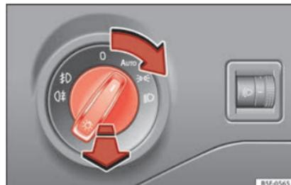
Fig. 35 Tablero de instrumentos: mando de las luces.
