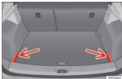
Fig. 164 En el maletero: tapas para guardar la bandeja portaobjetos.
