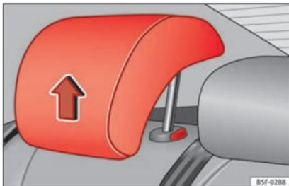
Fig. 85 Apoyacabezas en posición de uso.
