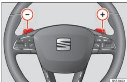
**Fig. 196** Volante: palancas para cambio automático.
