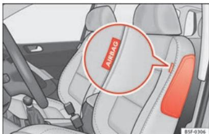
**Fig. 25** Airbag lateral en el asiento del conductor.
