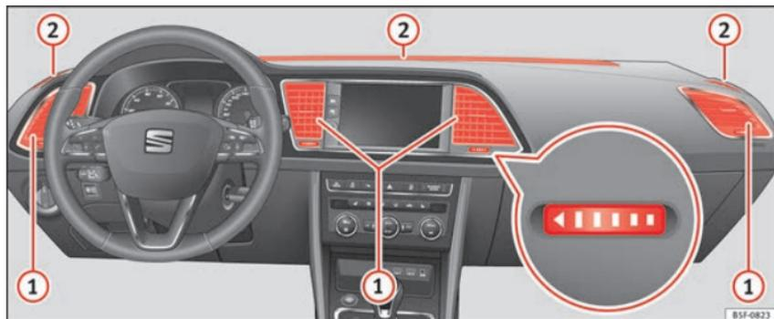
Fig. 186 En el tablero de instrumentos: difusores de aire.
