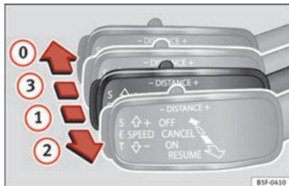
**Fig. 206** A la izquierda de la columna de la dirección: tercera palanca para manejar el control adaptativo de velocidad.
