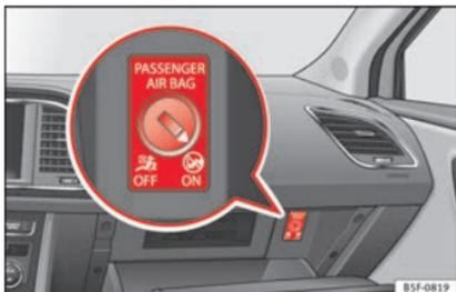
**Fig. 22** Conmutador del airbag frontal del acompañante.
