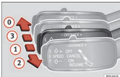
**Fig. 204** A la izquierda de la columna de la dirección: tercera palanca para manejar el control adaptativo de velocidad.
