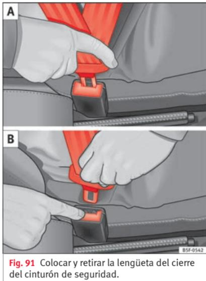
**Fig. 91** Colocar y retirar la lengüeta del cierre del cinturón de seguridad.
