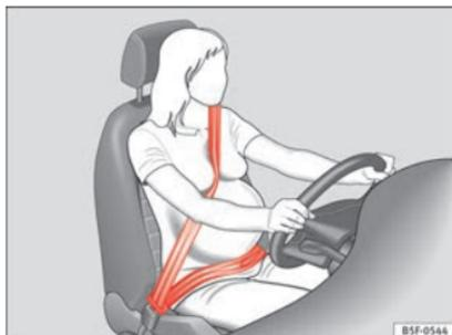
**Fig. 92** Colocación de la banda del cinturón en el caso de mujeres embarazadas.
