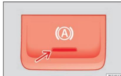
**Fig. 198** En la parte inferior de la consola central: tecla de la función Auto Hold.
