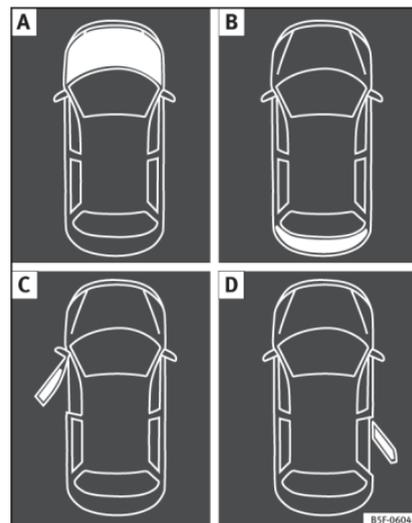
**Fig. 45** A: capó abierto; B: portón trasero abierto; C: puerta delantera izquierda abierta; D: puerta posterior derecha abierta (sólo en vehículos de 5 puertas).
