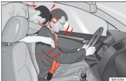
**Fig. 90** El ocupante del asiento trasero que no lleve puesto el cinturón de seguridad se verá lanzado hacia adelante sobre el conductor que sí lleva el cinturón.
