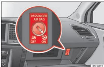
**Fig. 94** Conmutador del airbag frontal del acompañante.
