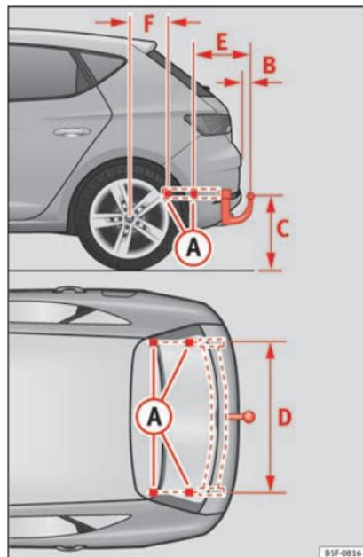
Fig. 245 Puntos de fijación del dispositivo de remolque.
