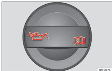
Fig. 237 Tapón de la boca de llenado de aceite del motor en el vano motor.
