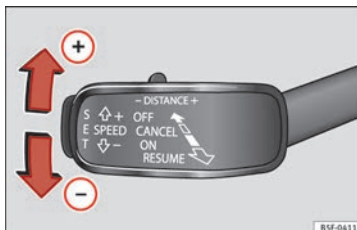
Fig. 198 A la izquierda de la columna de la dirección: tercera palanca para manejar el control adaptativo de velocidad.
