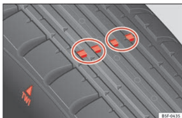
Fig. 239 Perfil del neumático: indicadores de desgaste.
