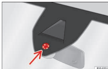
Fig. 145 Superficie sensible del sensor de lluvia.
