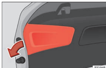
Fig. 118 Retirar la cubierta del portón del maletero.
