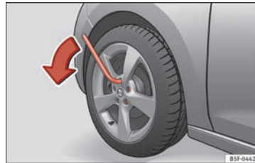
Fig. 73 Rueda: aflojar los tornillos de rueda.
