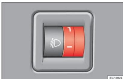
**Fig. 136** Al lado del volante: regulador del alcance de las luces.
