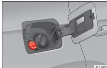
**Fig. 220** Tapón de la boca de llenado del depósito de AdBlue®.
