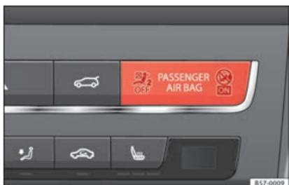
**Fig. 51** Testigo para desconexión de airbag del acompañante.
