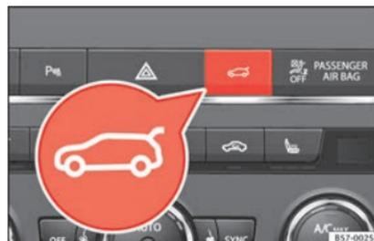
**Fig. 130** Consola central: tecla para abrir y cerrar el portón del maletero.
