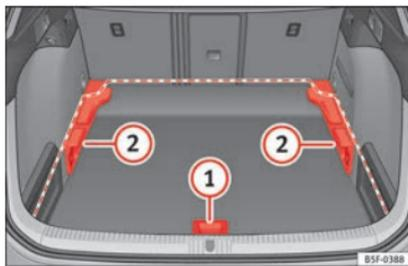
Fig. 158 Piso variable del maletero: posiciones.
