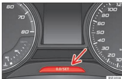
**Fig. 116** Cuadro de instrumentos: cuentakilómetros y tecla de puesta a cero.
