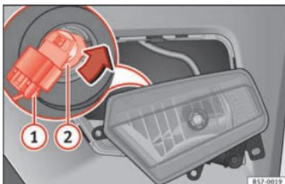
**Fig. 107** Faro antiniebla: desmontar el portalámparas
