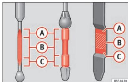
Fig. 59 Varilla de medición del nivel de aceite.
