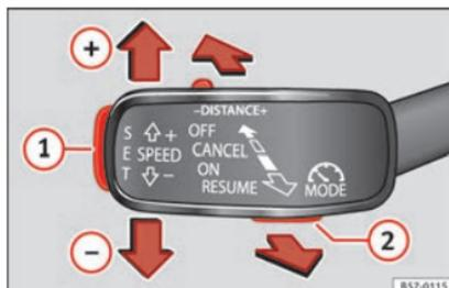
**Fig. 174** A la izquierda de la columna de la dirección: tercera palanca para manejar el limitador de velocidad.
