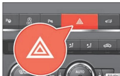
**Fig. 135** Tablero de instrumentos: conmutador de los intermitentes de emergencia.
