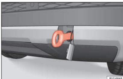
**Fig. 99** En el lado derecho del paragolpes trasero: argolla de remolque enroscada.
