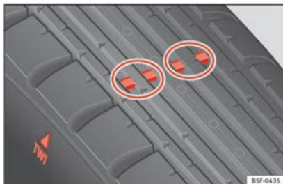
Fig. 225 Perfil del neumático: indicadores de desgaste.
