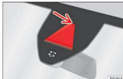
**Fig. 191** En el parabrisas: área de campo visual del sistema de aviso de salida del carril.
