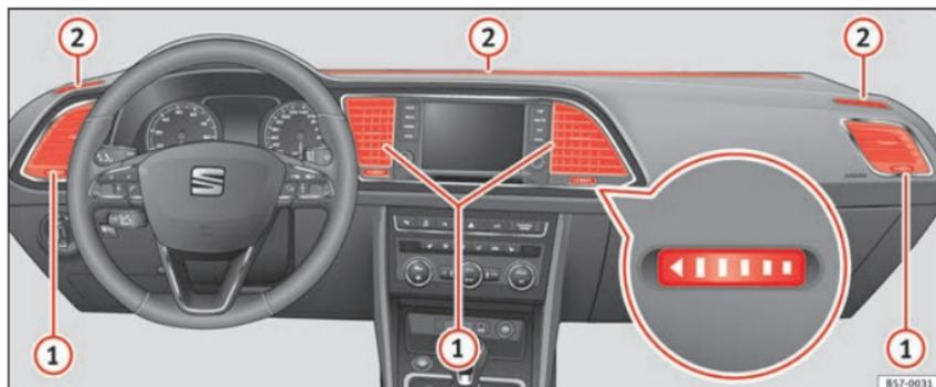
**Fig. 161** En el tablero de instrumentos: difusores de aire.
