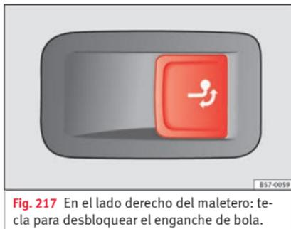
**Fig. 217** En el lado derecho del maletero: tecla para desbloquear el enganche de bola.
