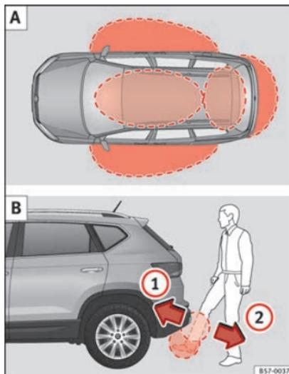
**Fig. 123** Sistema de cierre y arranque sin llave Keyless Access: **A** Zonas próximas. **B** Abrir el portón del maletero con apertura controlada por sensores (Easy Open).
