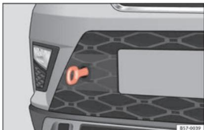
Fig. 74 Parte derecha del parachoques delantero: argolla de remolque enroscada.
