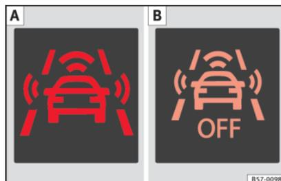
**Fig. 188** En la pantalla del cuadro de instrumentos: **A** Indicación del preaviso. **B** Detección de peatones desactivada.
