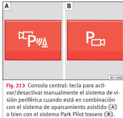
**Fig. 213** Consola central: tecla para activar/desactivar manualmente el sistema de visión periférica cuando está en combinación con el sistema de aparcamiento asistido (A) o bien con el sistema Park Pilot trasero (B).
