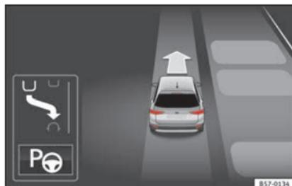
**Fig. 202** En la pantalla del cuadro de instrumentos: visualización del sistema de aparcamiento asistido con visualización reducida.
