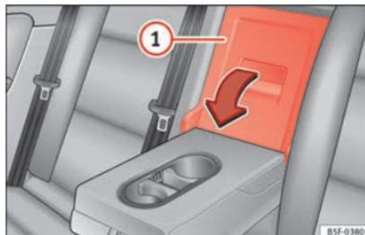
**Fig. 152** En el respaldo del asiento trasero: apertura de la trampilla.
