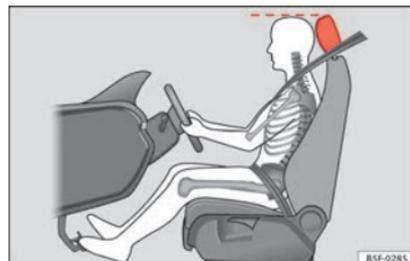
**Fig. 82** Posición correcta del apoyacabezas del conductor.
