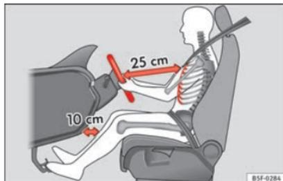
**Fig. 81** Distancia correcta entre el conductor y el volante.
