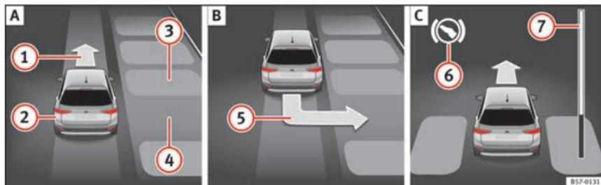
**Fig. 204** En la pantalla del cuadro de instrumentos: aparcamiento en batería. **A** Buscar un hueco de aparcamiento. **B** Posición para aparcamiento. **C** Maniobrar.
