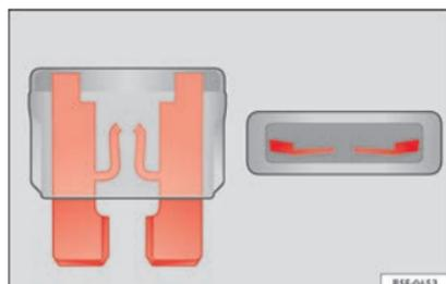
**Fig. 66** Representación de un fusible fundido.
