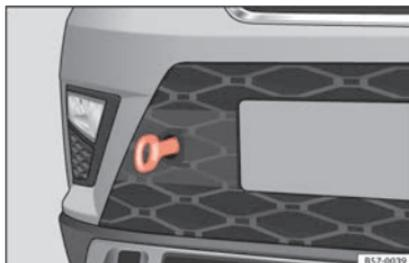
**Fig. 97** En el lado derecho del paragolpes delantero: argolla de remolque enroscada.
