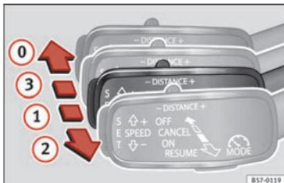
**Fig. 178** A la izquierda de la columna de la dirección: tercera palanca para manejar el control adaptativo de velocidad.
