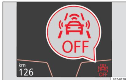
**Fig. 186** En la pantalla del cuadro de instrumentos: indicación de Front Assist desactivado.
