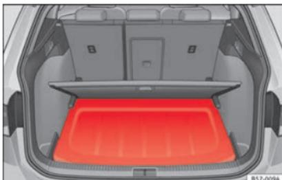
**Fig. 151** En el maletero: colocación de la bandeja portaobjetos.
