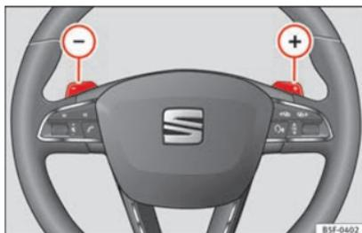
**Fig. 168** Volante: palancas para cambio automático.
