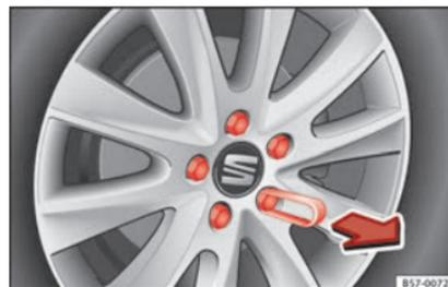
**Fig. 69** Rueda: tornillos de la rueda con capuchones.
