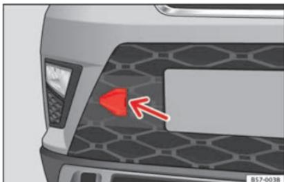
**Fig. 96** En el lado derecho del paragolpes delantero: retirar la tapa.
