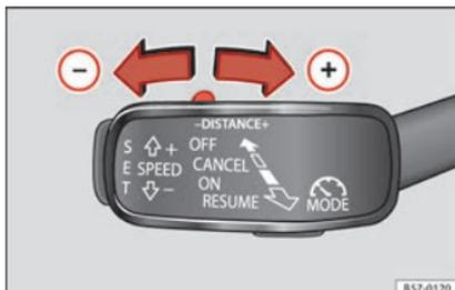
**Fig. 181** Palanca de mando: ajustar la distancia.
