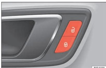
Fig. 2 Puerta del conductor: conmutador del cierre centralizado.
