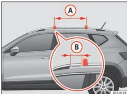
**Fig. 160** Puntos de fijación de las barras longitudinales para el portaequipajes del techo.
