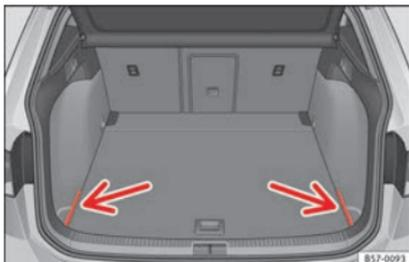
**Fig. 150** En el maletero: tapas para guardar la bandeja portaobjetos.
