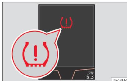
Fig. 227 Cuadro de instrumentos: aviso de pérdida de presión de los neumáticos.
