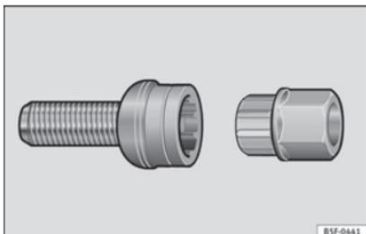
Fig. 70 Tornillo antirrobo de la rueda con capuchón y adaptador.
