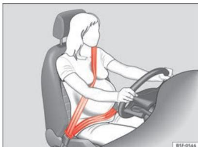
**Fig. 91** Colocación de la banda del cinturón en el caso de mujeres embarazadas.
