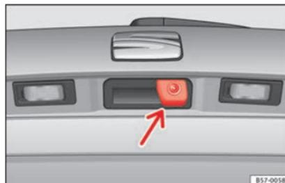
**Fig. 215** En la maneta del portón trasero: ubicación de la cámara del asistente para marcha atrás.
