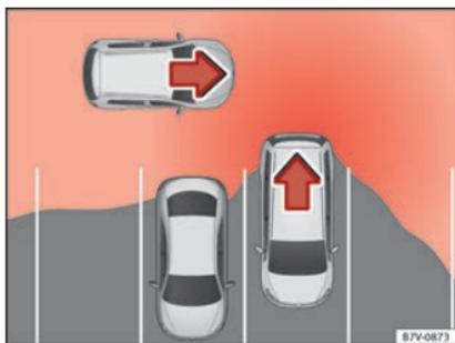
**Fig. 196** Representación esquemática del asistente de desaparcamiento: zona vigilada alrededor del vehículo que está desaparcando.
