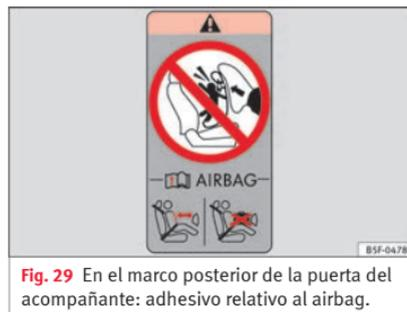
En el parasol del acompañante y/o en el marco posterior de la puerta del acompañante, hay un adhesivo con información importante sobre el airbag del acompañante.
