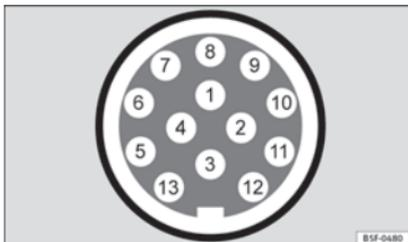
**Fig. 218** Representación esquemática: asignación de los pines de la toma de corriente para remolque.
