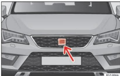
**Fig. 177** En el frontal tras el emblema de SEAT: sensor de radar.
