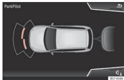
Fig. 210 Visualización del Park Pilot en la pantalla con remolque enganchado.
