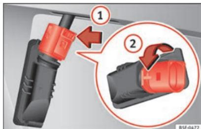
**Fig. 113** Luz de matrícula: desmontar el portalámparas.
