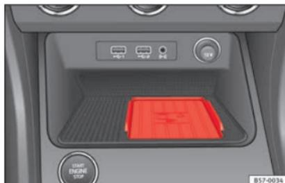
**Fig. 120** Consola central: Connectivity Box.
