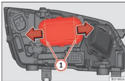
**Fig. 102** En el vano motor: retirar la tapa.
