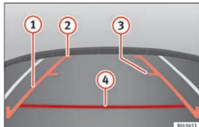
**Fig. 216** Visualización en la pantalla del sistema Easy Connect: líneas de orientación.
