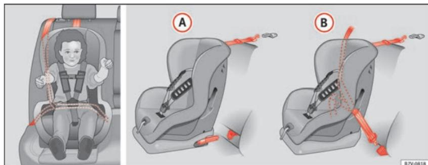
La ilustración » fig. 30 A muestra la fijación básica del sistema de retención para niños con las anillas de sujeción inferiores y el cinturón de sujeción superior. La ilustración » fig. 30 B muestra la fijación del sistema de retención para niños con el cinturón de seguridad del vehículo.
