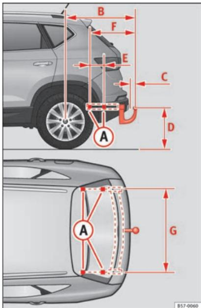
**Fig. 219** Cotas y puntos de fijación para el montaje posterior de un dispositivo de remolque.
