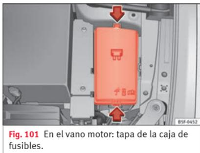
Fig. 101 En el vano motor: tapa de la caja de fusibles.
