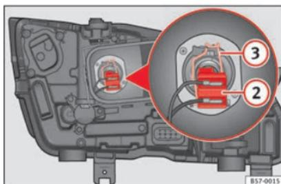
**Fig. 103** En el vano motor: lámpara de luz de cruce.
