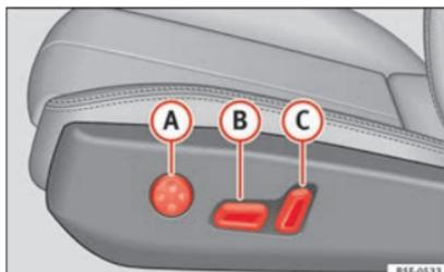
**Fig. 14** Asiento del conductor: ajuste eléctrico del asiento.
