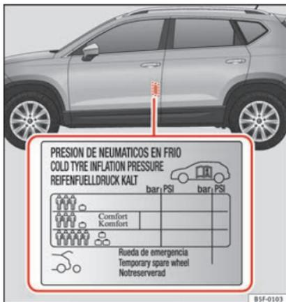
Fig. 224 Ubicación del adhesivo de la presión de inflado de los neumáticos.
