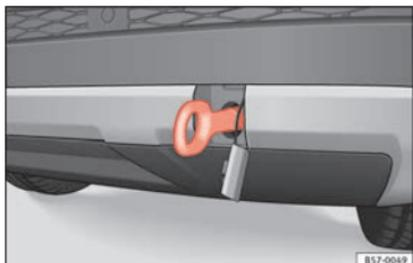
Fig. 75 Parte derecha del parachoques trasero: argolla de remolque enroscada.
