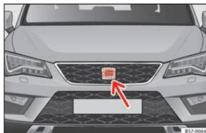
Fig. 185 En el frontal tras el emblema de SEAT: sensor de radar.
