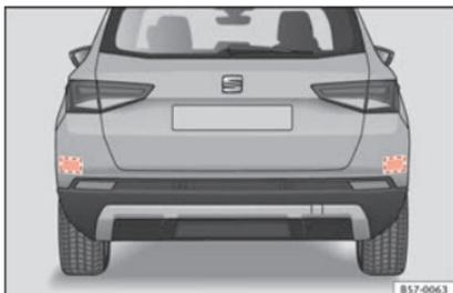
**Fig. 193** Vista trasera del vehículo: zonas de los sensores de radar.
