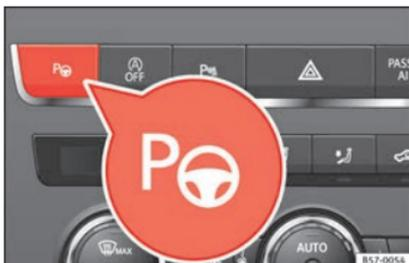
**Fig. 200** En la parte superior de la consola central: tecla para conectar el sistema de aparcamiento asistido.
