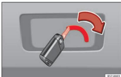
Fig. 8 Detalle del maletero: desbloqueo de emergencia.
