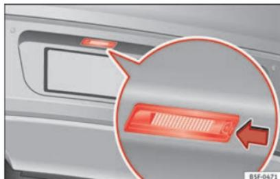
**Fig. 112** En el parachoques posterior: luz de matrícula.
