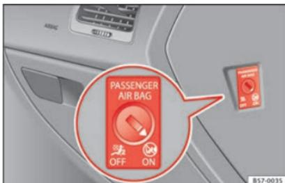
**Fig. 93** Conmutador del airbag frontal del acompañante.
