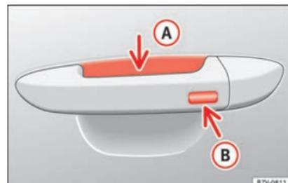
**Fig. 124** Sistema de cierre y arranque sin llave Keyless Access: superficie sensora **A** de desbloqueo en la parte interior de la manija de la puerta y superficie sensora **B** de bloqueo en la parte exterior de la manija.
