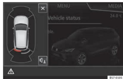
**Fig. 208** Indicación en miniatura de la activación automática
