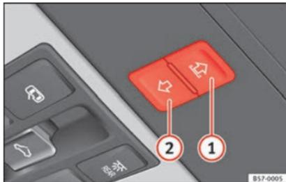
**Fig. 133** En el revestimiento interior del techo: teclas de la cortinilla parasol.
