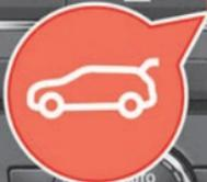
de la llave del vehículo durante aprox. 1 segundo. Si el vehículo está bloqueado, se desbloquea solamente el portón del maletero (las puertas permanecen bloqueadas).
