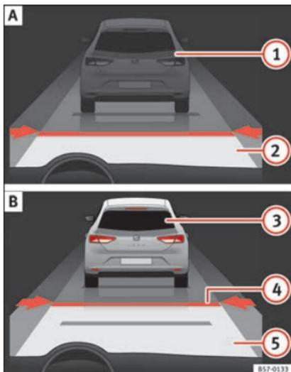
**Fig. 176** En la pantalla del cuadro de instrumentos: (A) ACC inactivo temporalmente, vehículo detectado delante, distancia temporal ajustada. (B) ACC activo, vehículo detectado delante, se ajusta una distancia temporal.
