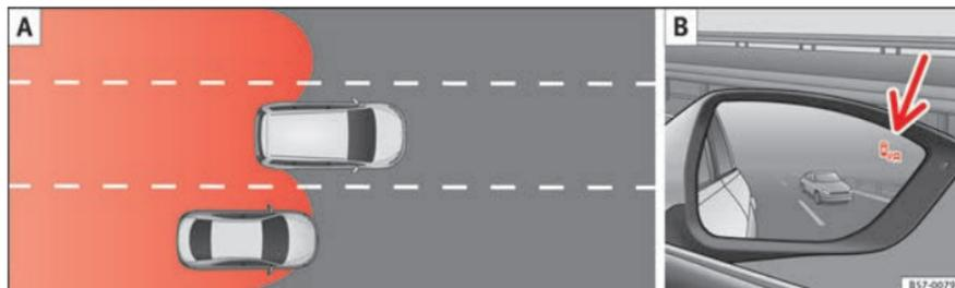
**Fig. 195** Representación esquemática: **A** Situación en un adelantamiento e incorporación posterior al carril derecho. **B** Indicación del asistente de ángulo muerto en el retrovisor exterior derecho.
