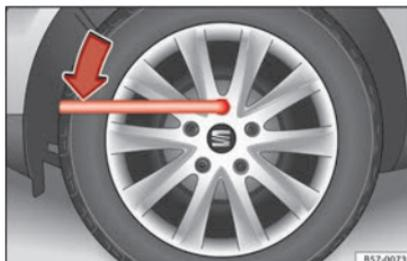
Fig. 71 Rueda: aflojar los tornillos de rueda.
