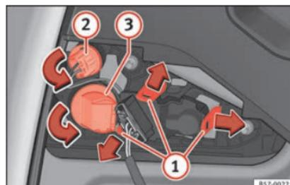
Fig. 111 Desmontar el portalámparas.
