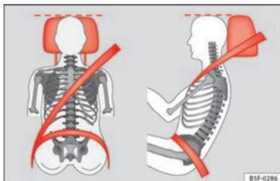
**Fig. 83** Apoyacabezas ajustado correctamente visto de frente y lateralmente.
