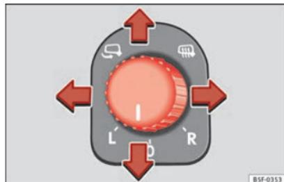
Fig. 140 Puerta del conductor: mando para el retrovisor exterior.
