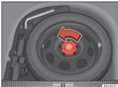
**Fig. 228** Rueda de emergencia: piso de carga alzado.
