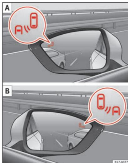
**Fig. 192** En los retrovisores exteriores: indicación del asistente de ángulo muerto. » »
