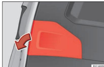
Fig. 110 Portón del maletero abierto: retirar la tapa.
