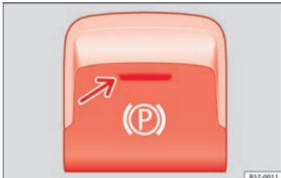
**Fig. 165** En la parte inferior de la consola central: tecla del freno de estacionamiento electrónico.
