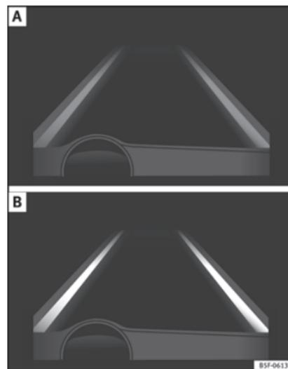
Fig. 189 En la pantalla del cuadro de instrumentos: indicación en la pantalla del sistema de aviso de salida del carril (ejemplo 1).
