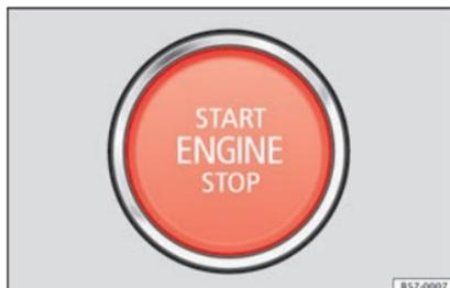
**Fig. 164** En la parte inferior de la consola central: pulsador de arranque.
