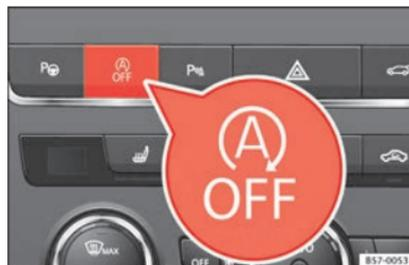
**Fig. 169** Consola central: tecla del sistema Start-Stop.
