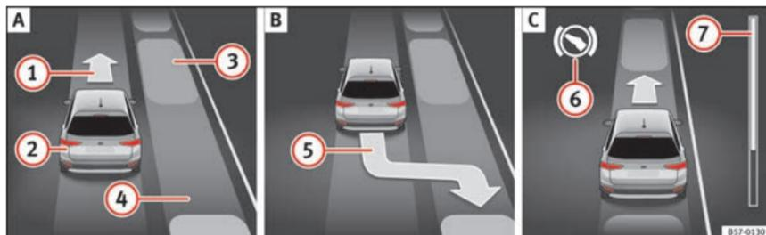
**Fig. 203** En la pantalla del cuadro de instrumentos: aparcamiento en línea. **A** Buscar un hueco de aparcamiento. **B** Posición para aparcamiento. **C** Maniobrar.
