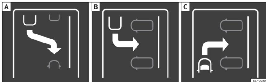
**Fig. 201** Cuadro general de las visualizaciones reducidas para los modos de aparcamiento: **A**) Aparcar en línea marcha atrás. **B**) Aparcar en batería marcha atrás. **C**) Aparcar en batería marcha adelante.
