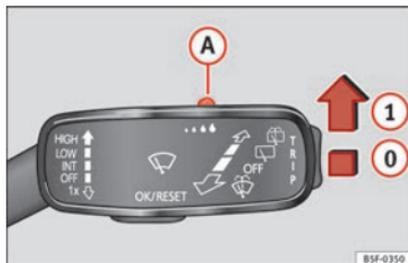
Fig. 138 Palanca del limpiaparabrisas: ajustar el sensor de lluvia (A).
