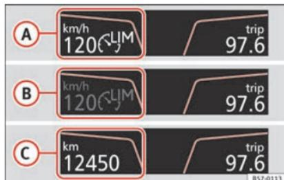
**Fig. 172** En la pantalla del cuadro de instrumentos: indicaciones del estado del limitador de velocidad.
