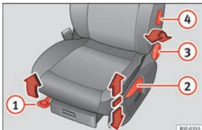
**Fig. 13** Asientos delanteros: ajuste manual del asiento.
