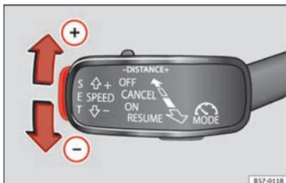
**Fig. 179** A la izquierda de la columna de la dirección: tercera palanca para manejar el control adaptativo de velocidad.
