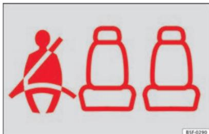
**Fig. 86** Cuadro de instrumentos: indicación de plaza posterior derecha ocupada y abrochado el cinturón correspondiente.
