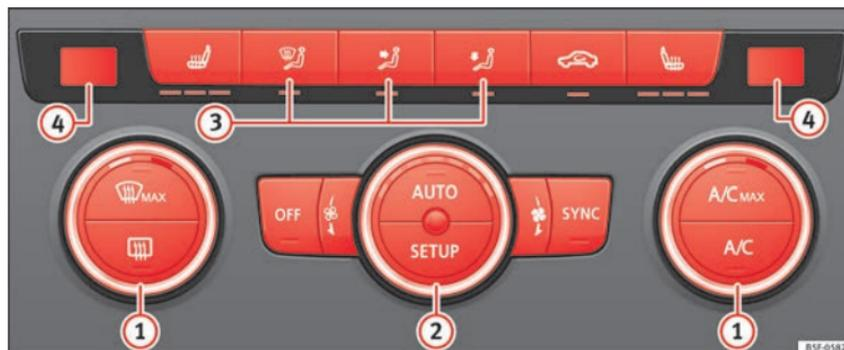
Fig. 55 En la consola central: mandos del Climatronic.
