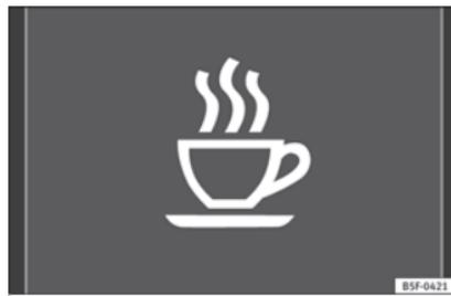
**Fig. 199** En la pantalla del cuadro de instrumentos: símbolo de detección de cansancio.
