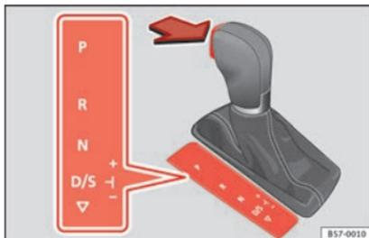
**Fig. 166** Bloqueo de la palanca selectora.
