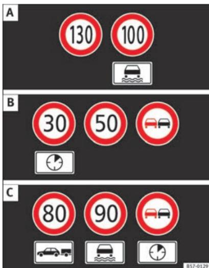
**Fig. 198** En la pantalla del cuadro de instrumentos: ejemplos de limitaciones de velocidad o prohibiciones de adelantamiento reconocidas con sus respectivos paneles complementarios.
