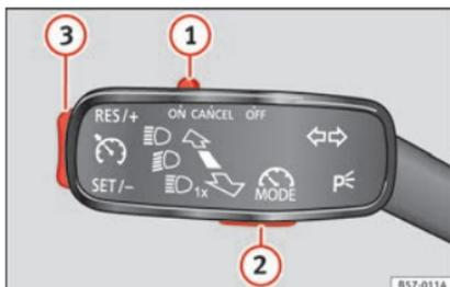
**Fig. 173** A la izquierda de la columna de la dirección: mando y teclas para manejar el limitador de velocidad.
