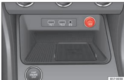
**Fig. 148** Consola central: toma de corriente de 12 voltios.
