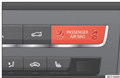
**Fig. 94** Testigo para desconexión de airbag del acompañante.
