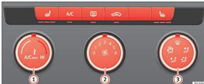
**Fig. 56** En la consola central: mandos del aire acondicionado manual.
