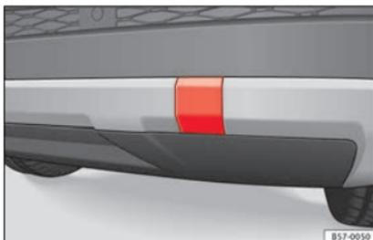
**Fig. 98** En el lado derecho del paragolpes trasero: retirar la tapa.
