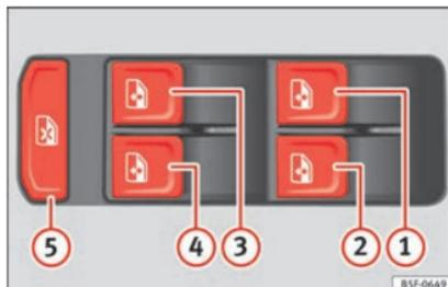
**Fig. 131** Detalle de la puerta del conductor: mandos para las ventanillas.
