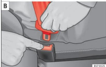
**Fig. 90** Colocar y retirar la lengüeta del cierre del cinturón de seguridad.
