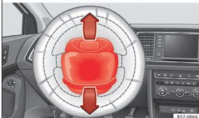
**Fig. 20** Airbag del conductor en el volante.
