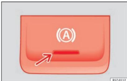
**Fig. 170** En la parte inferior de la consola central: tecla de la función Auto Hold.
