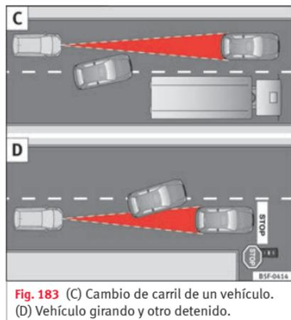
El control adaptativo de velocidad (ACC) cuenta con ciertas limitaciones físicas inherentes al sistema. Por ejemplo, algunas reacciones del ACC, bajo determinadas circunstancias, pueden resultar inesperadas o efectuarse a destiempo desde el punto de vista del conductor. Por ello, se ha de estar siempre atento para intervenir si fuera preciso.
