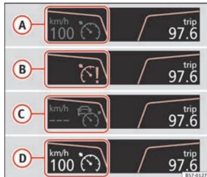
Fig. 171 Pantalla del cuadro de instrumentos: indicaciones de estado del GRA.
