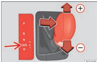
**Fig. 167** Consola central: cambiar con tiptronic.
