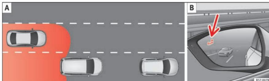
**Fig. 194** Representación esquemática: **A** Situación en un adelantamiento con tráfico en la parte trasera. **B** Indicación del asistente de ángulo muerto en el retrovisor exterior izquierdo.
