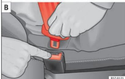
**Fig. 16** Colocar y retirar la lengüeta del cierre del cinturón de seguridad.
