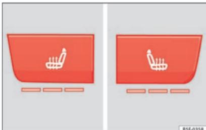
Fig. 142 En la consola central: mandos para la calefacción de los asientos delanteros.
