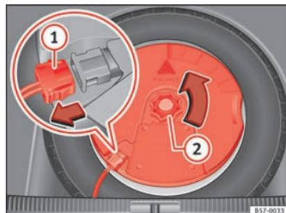
**Fig. 229** En el maletero: desmontar el subwoofer.
