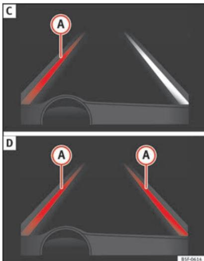
**Fig. 190** En la pantalla del cuadro de instrumentos: indicación en la pantalla del sistema de aviso de salida del carril (ejemplo 2).
