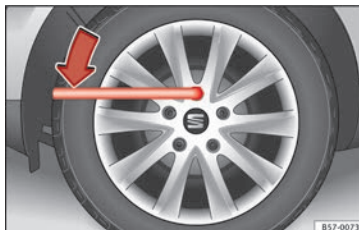
Fig. 81 Cambio de rueda: aflojar los tornillos de rueda.
