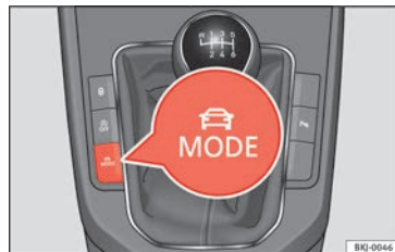
Fig. 206 Junto a la palanca de cambios: tecla MODE .
