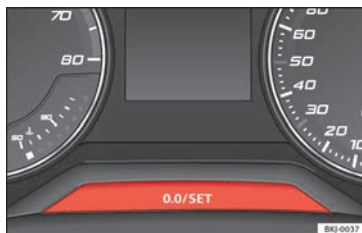
Fig. 126 Cuadro de instrumentos: cuentakilómetros y tecla de puesta a cero.
