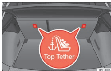
Fig. 32 Posición de las anillas Top Tether en la parte posterior del asiento trasero.
