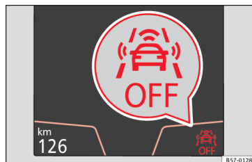
Fig. 191 En la pantalla del cuadro de instrumentos: indicación de Front Assist desactivado.
