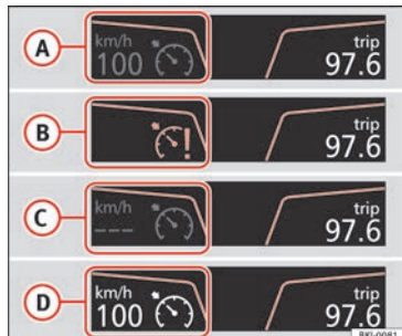
Fig. 185 Pantalla del cuadro de instrumentos: indicaciones de estado del GRA.
