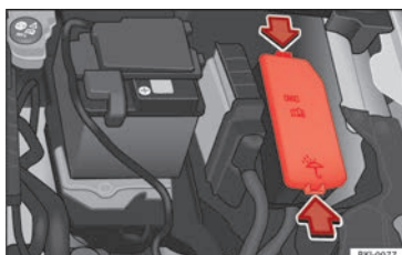
Fig. 71 En el vano motor: tapa de la caja de fusibles.
