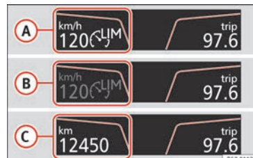
Fig. 186 En la pantalla del cuadro de instrumentos: indicaciones del estado del limitador de velocidad.
