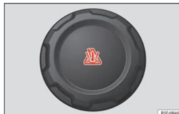
Fig. 67 Vano motor: tapón del depósito de expansión del líquido refrigerante.
