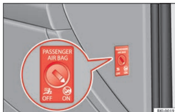
Fig. 103 Conmutador con llave para activar y desactivar el airbag del acompañante.
