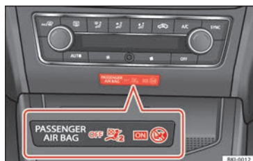
Fig. 23 Parte central del tablero de instrumentos: testigo de control de la desactivación del airbag del acompañante.
