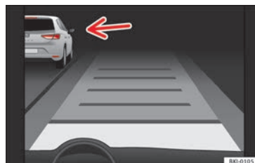
Fig. 198 En la pantalla del cuadro de instrumentos: ACC activo, vehículo detectado por la izquierda
