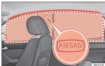
Fig. 26 Ubicación y zona de despliegue del airbag para la cabeza.
