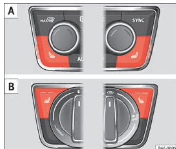
Fig. 154 En la consola central: mandos para la calefacción de los asientos delanteros. A : versión con Climatronic. B : versión con aire acondicionado manual.
