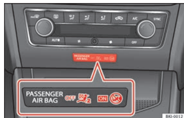
Fig. 104 Parte central del tablero de instrumentos: testigo de control de la desactivación del airbag del acompañante.
