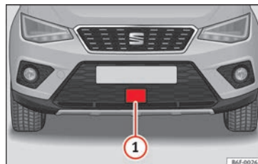
Fig. 195 En el paragolpes delantero: sensor de radar.
