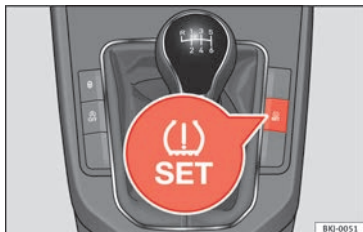
Fig. 242 Consola central: tecla del sistema de control de los neumáticos.
