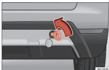
Fig. 109 Parte derecha del parachoques trasero: argolla de remolque enroscada.
