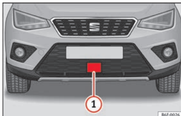
Fig. 190 En el paragolpes delantero: sensor de radar.
