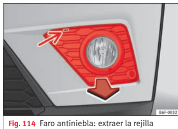
Fig. 114 Faro antiniebla: extraer la rejilla
