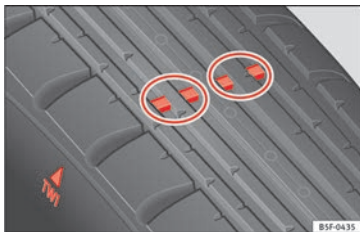
Fig. 240 Indicadores de desgaste del perfil del neumático.
