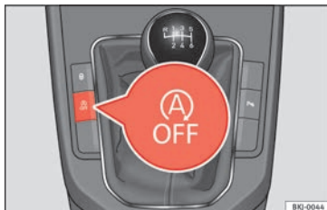
Fig. 184 Consola central: tecla del sistema Start-Stop.
