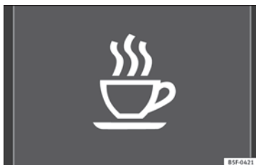
Fig. 208 En la pantalla del cuadro de instrumentos: símbolo de detección de cansancio.
