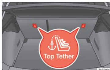
Fig. 36 Posición de las anillas Top Tether en la parte posterior del asiento trasero.
