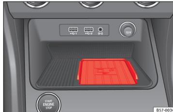
**Fig. 82** En la consola central: alojamiento para la conexión del teléfono móvil.
